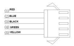
Red wire: Anode(24V/36V/48V/52V)
