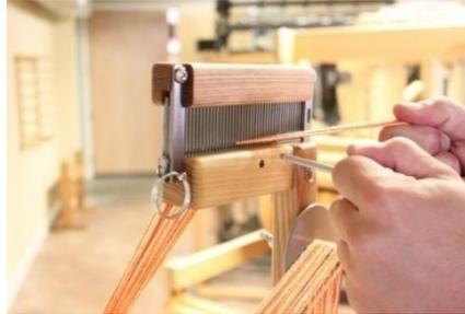
**Figure 48 - Retirer Raddle de position de tête**
