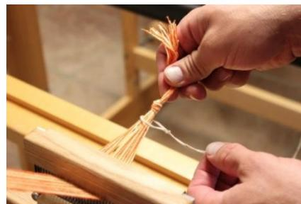
**Figure 50 - Placez le cordon d'extension autour du filetage**
