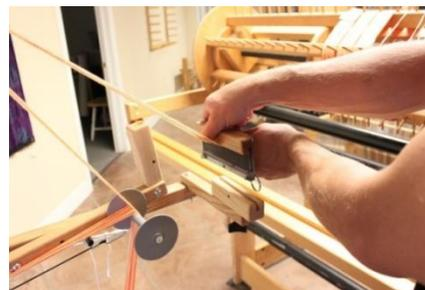
**Figure 49 - Place Raddle en position inférieure**
