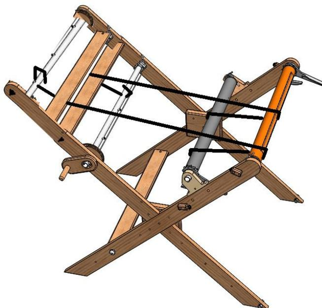
**Figure 53 - Chemin de la chaîne pour deux faisceaux**
