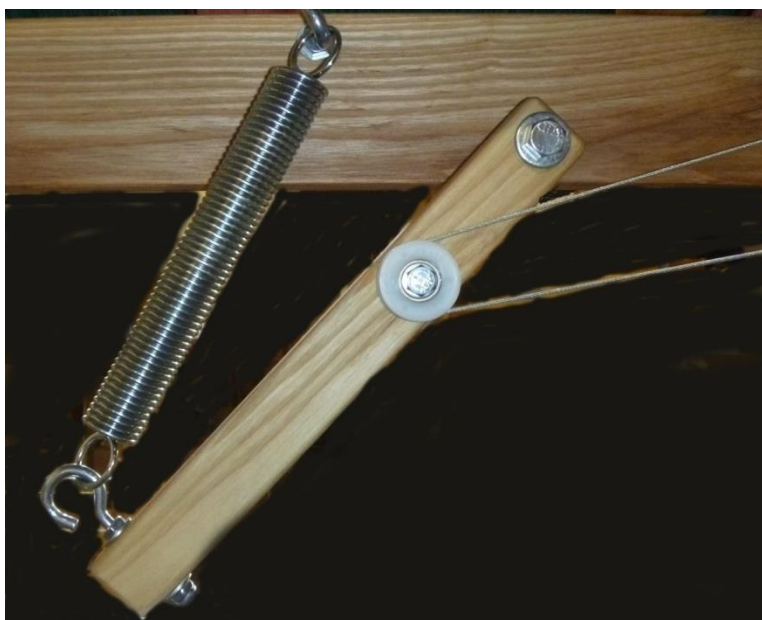
Figure 41 - Le ressort et le cordon de retour
