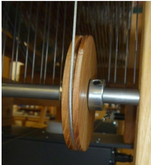
Figure 43 - Câble de poulie de retour
