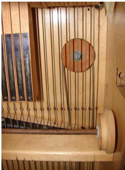
Figure 44 - Câble de pédale autour de Dobby Pulley
