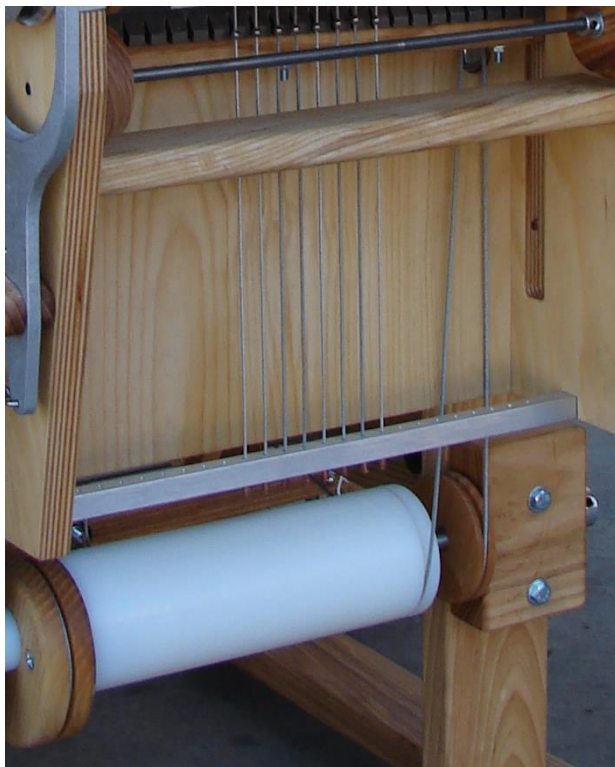
Figure 45 - Cylindre à Dobby Bras Câble
