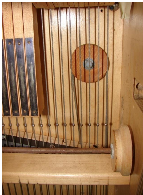
Figura 44 - Cable de pedal alrededor de la polea Dobby
