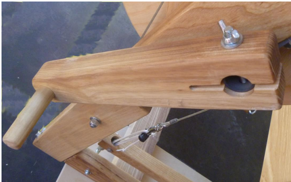
Figura 35 - Asa de viga de urdimbre
