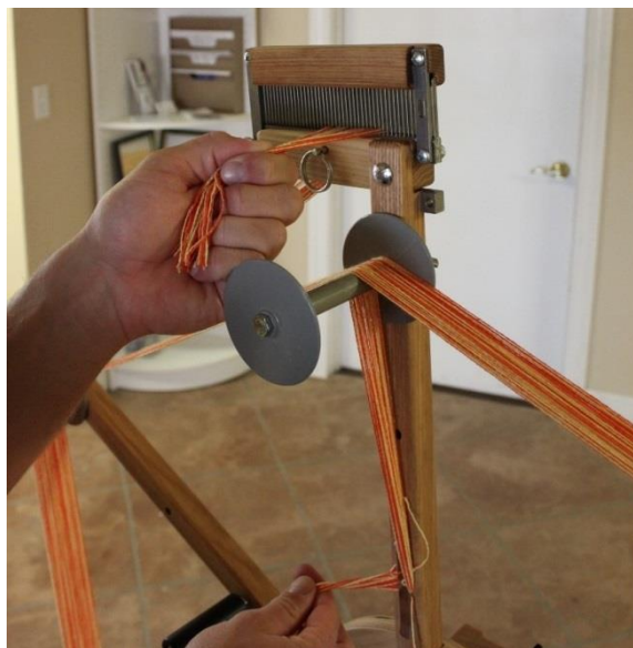
Abbildung 59 - Gewinde bei Raddle halten
