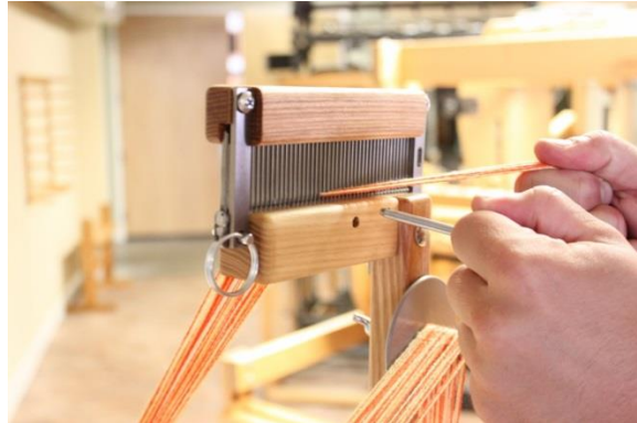
Abbildung 60 - Raddle aus der oberen Position entfernen
