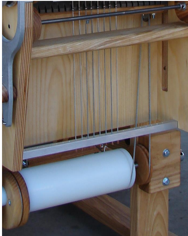
Abbildung 45 - Kabel zwischen Zylinder und Dobbyarm
