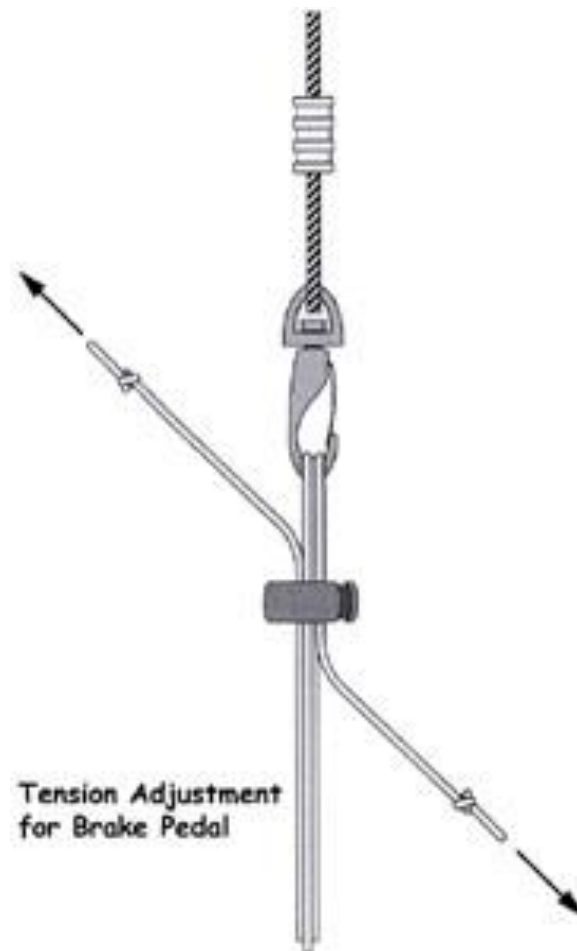
Abbildung 40 - Spannungseinstellung für Bremspedal
