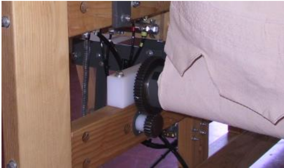
Figura 50 - Avance automático de almacenamiento de ropa
