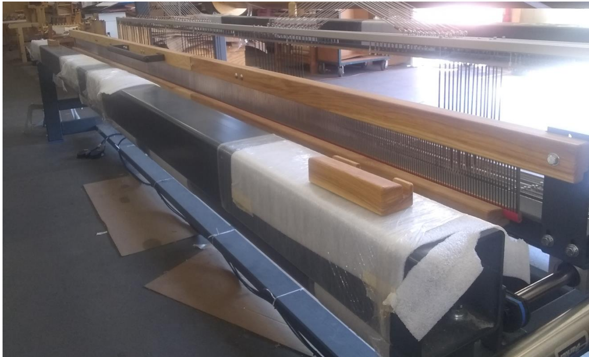
Figura 24 - Viga de tela de acero
