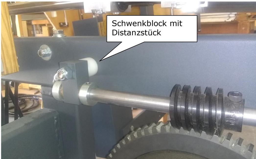
**Abbildung 28 - Drehblock für Schneckengetriebe**
