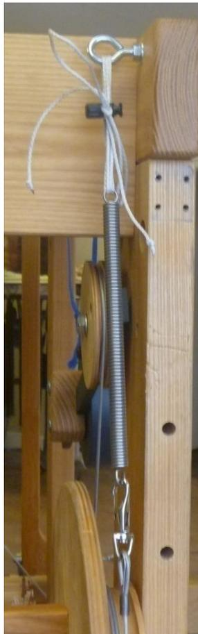
**Abbildung 59 - Bindung der oberen Spannung**
