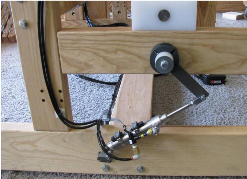
**Abbildung 49 - Stehlager und automatischer Vorschub**
