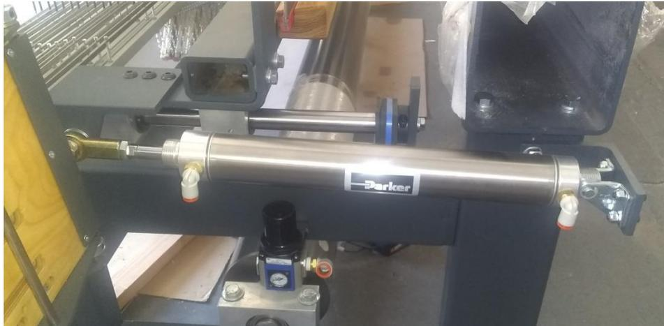
**Abbildung 46 - Luftzylinder**
