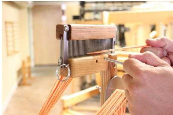
**Abbildung 75 - Raddle aus der oberen Position entfernen**
