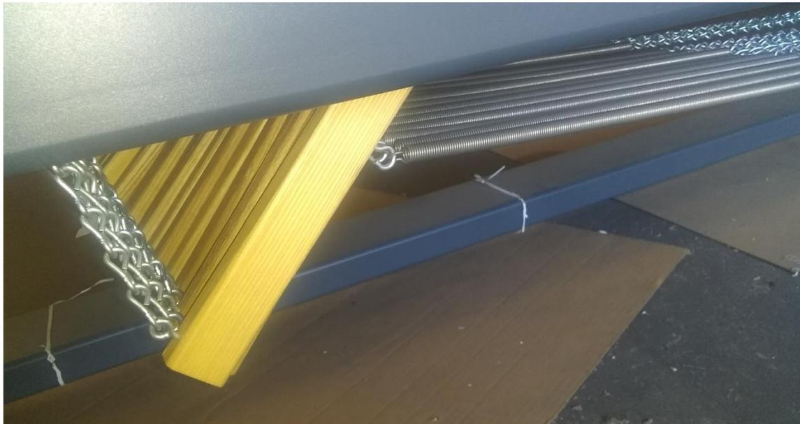
**Abbildung 20 - Kabelbaumfedern am Hebel**
