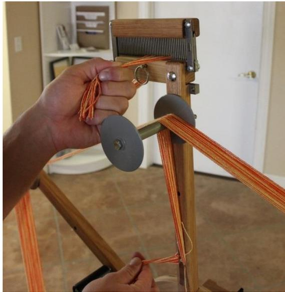
**Abbildung 74 - Halten Sie die Gewinde am Raddle**
