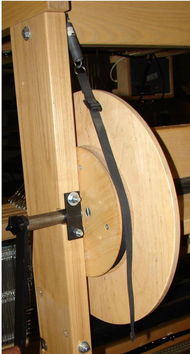
**Abbildung 36 - Bremszugriemen**
