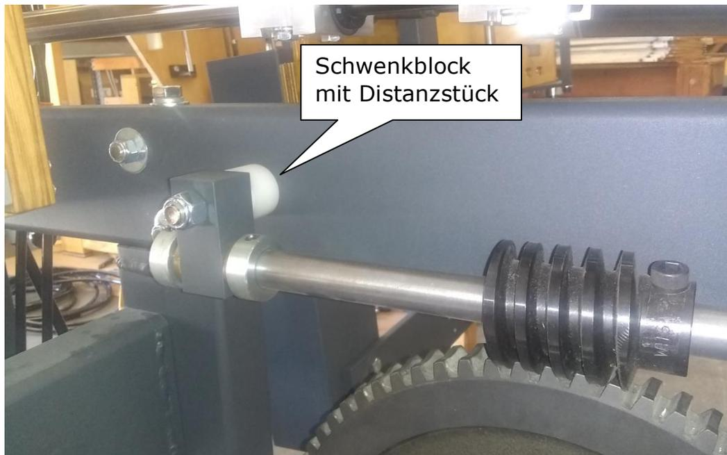
**Abbildung 55 - Drehblock für Schneckengetriebe**
