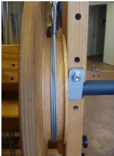
**Abbildung 58 - Spannkabel um die Bremstrommel**
