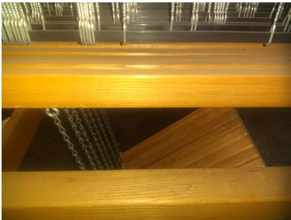
**Abbildung 18 - Mit dem Kabelbaum verbundener Federhebel**
