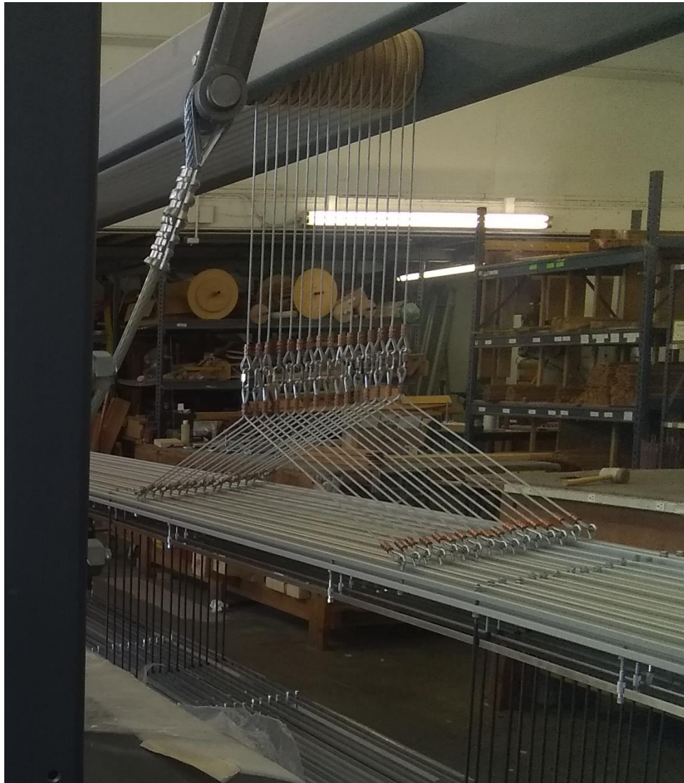
Figure 16 - Câbles de faisceau sur un métier plus long
