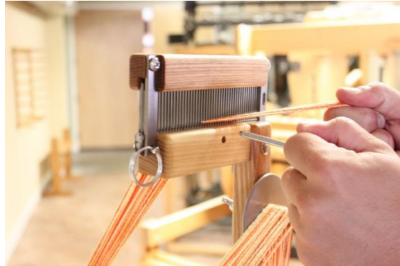
Figure 75 - Retirer le raddle de la position supérieure
