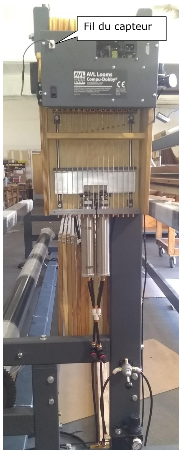
Figure 40 - Compu-dobby pneumatique sur métier à tisser
