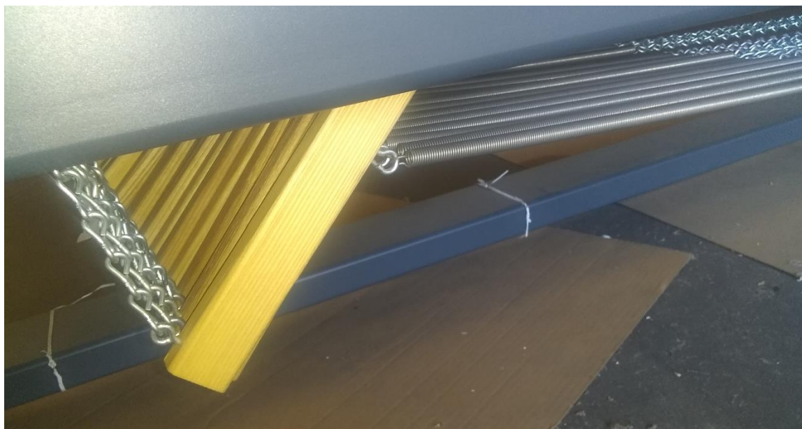
Figure 20 - Ressorts du harnais fixés au levier
