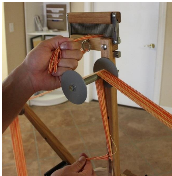
Figure 74 - Maintenez les threads au raddle
