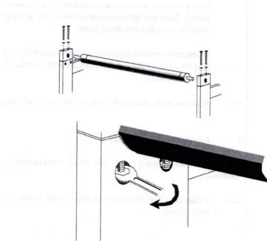
Figure 52 - Installation de la poutre en tissu
