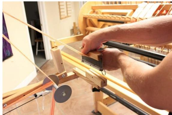
**Figura 98 - Coloque Raddle en la posición inferior**
