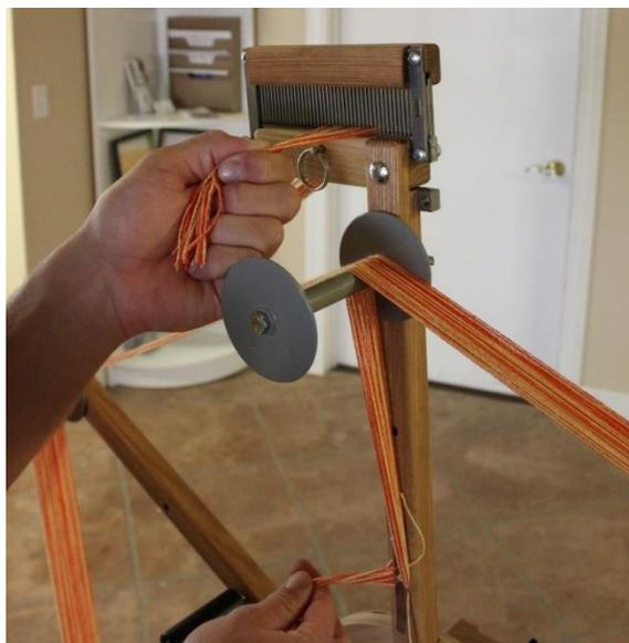
**Figura 96 - Mantenga los hilos en Raddle**
