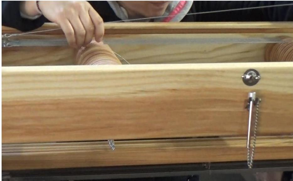
**Figura 25 - Colocación de los cables del arnés superior**
