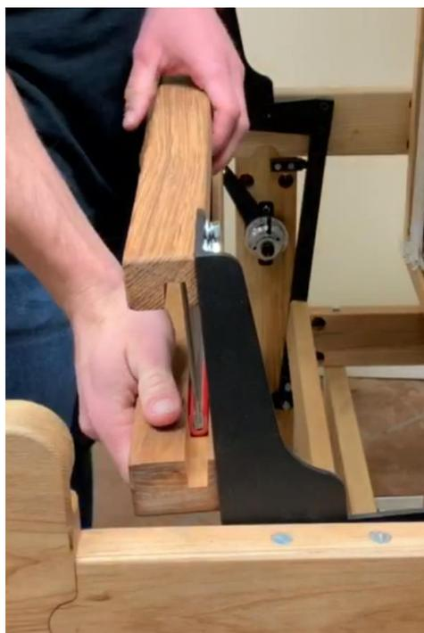
**Figura 47 - Empuje hacia abajo el soporte inferior**
