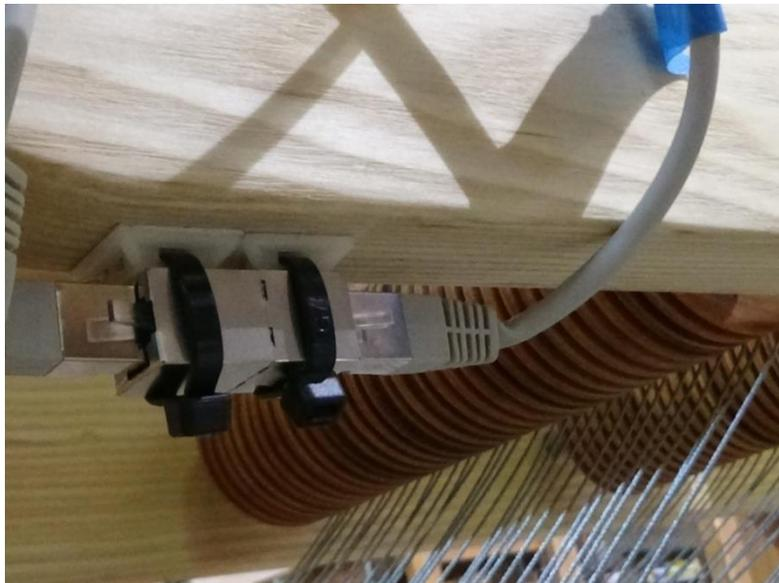
**Figura 72 - Acoplador de cable**
