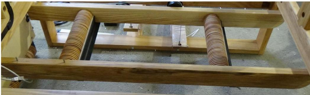
**Figura 12 - Conjunto de soporte de polea del arnés inferior**
