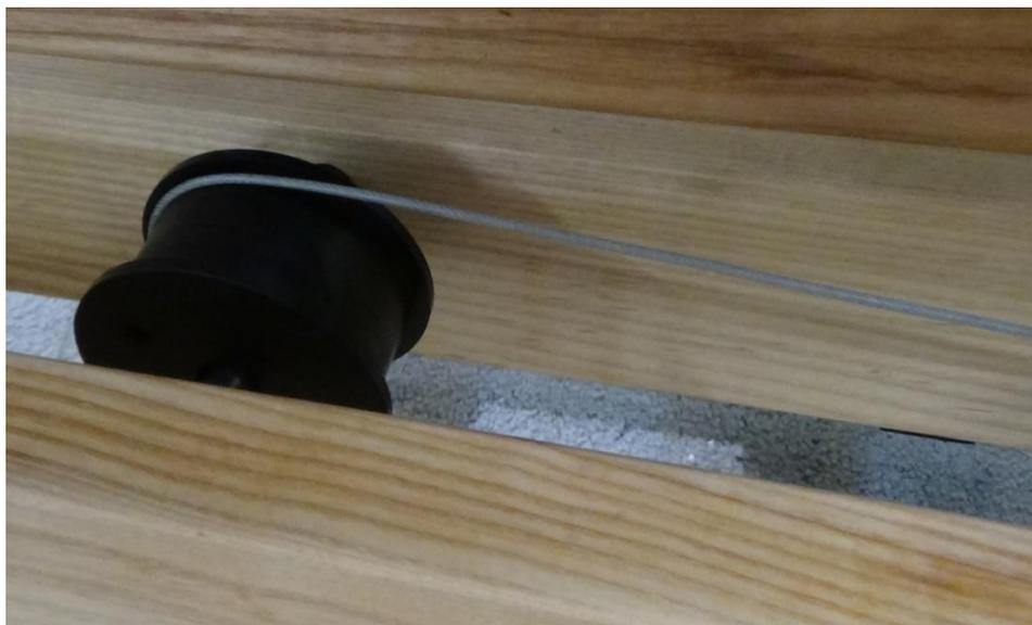
**Figura 32 - Polea izquierda del pedal con cable**
