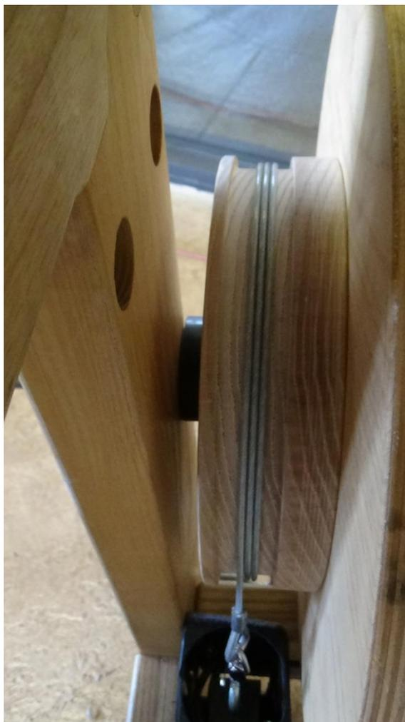
**Figura 65 - Sistema de tensión desde el telar interno**
