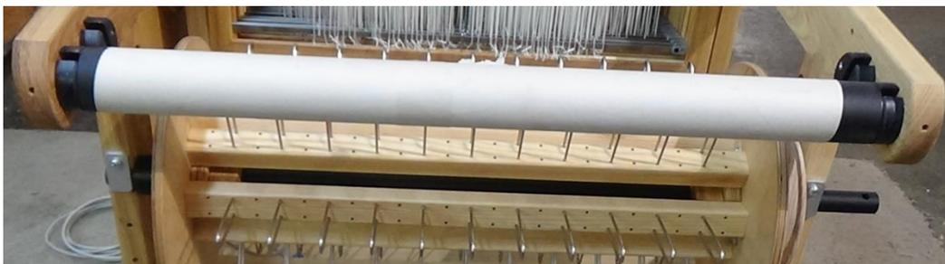
**Figura 68 - Haz de separación**
