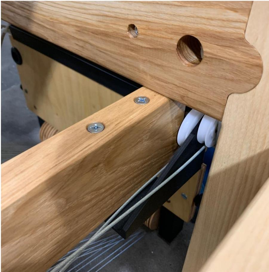
**Figura 24 - Conjunto de polea de pedal inferior desde el telar interno**
