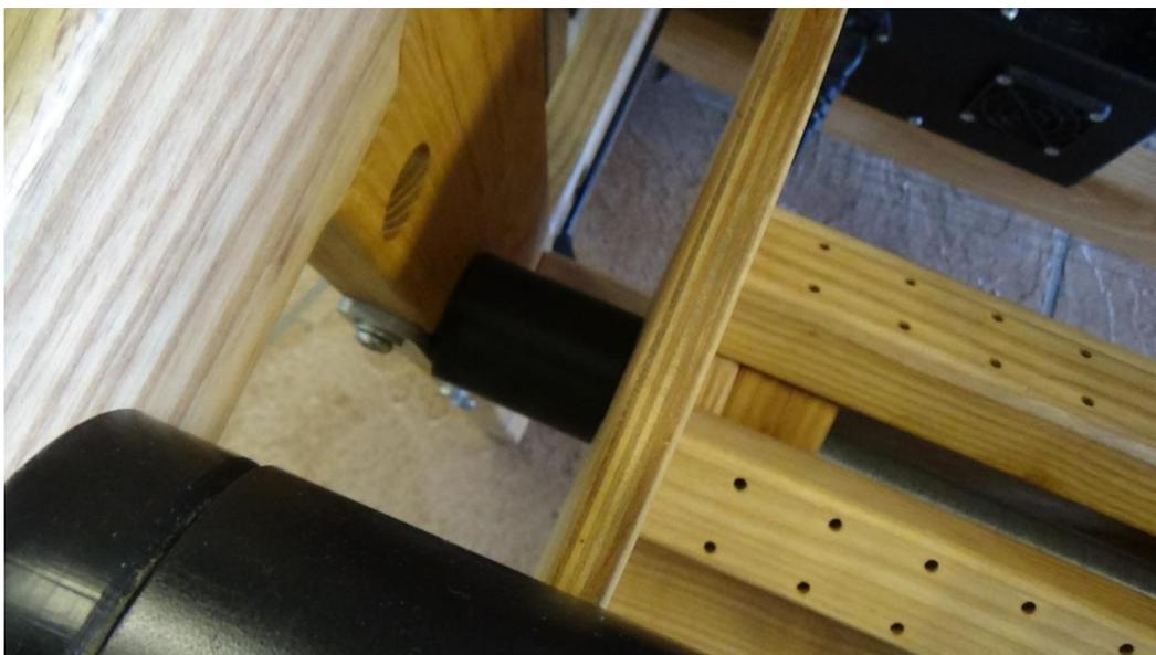
**Figura 61 - Espaciador de haz de deformación en el lado sin freno**
