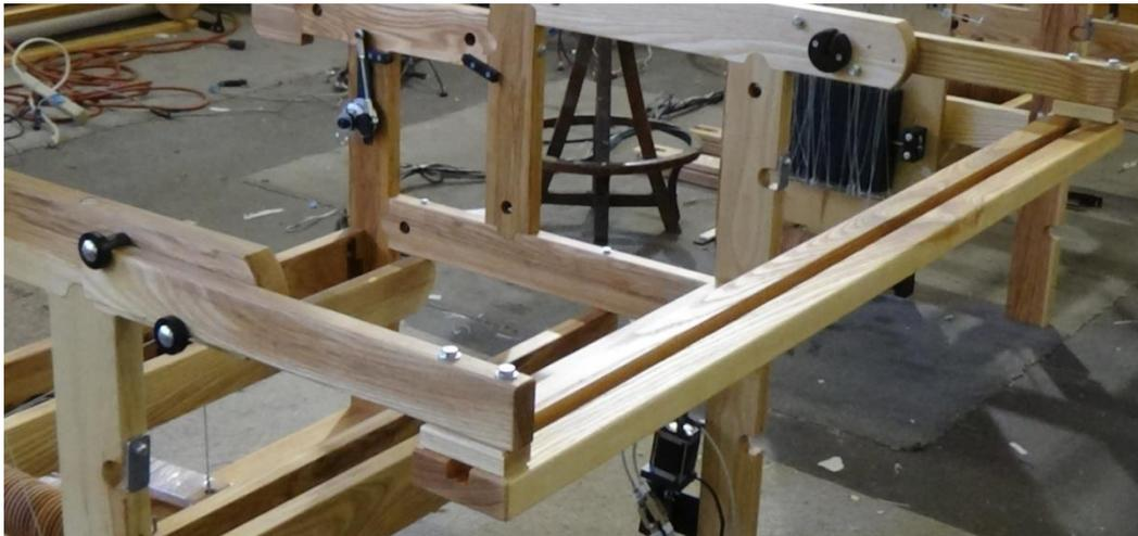
**Figura 81 - Fije la pista y los brazos de montaje**
