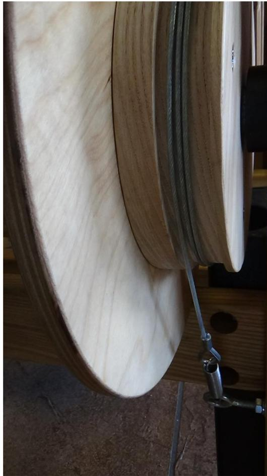
**Figura 64 - Sistema de tensión desde la parte posterior del telar**
