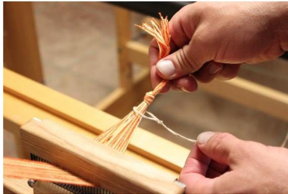
**Figura 99 - Coloque el cable de extensión alrededor del paquete de hilos**
