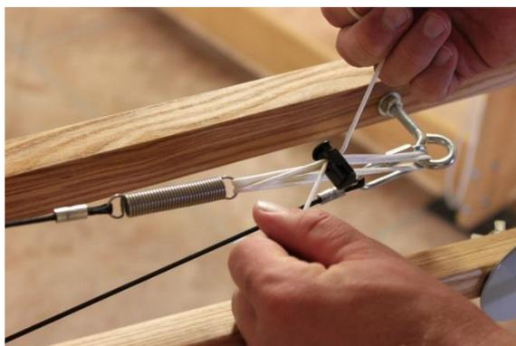
**Figura 92 - Ajuste la tensión de desconexión**
