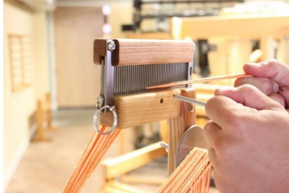
**Figura 97 - Retire Raddle de la posición superior**
