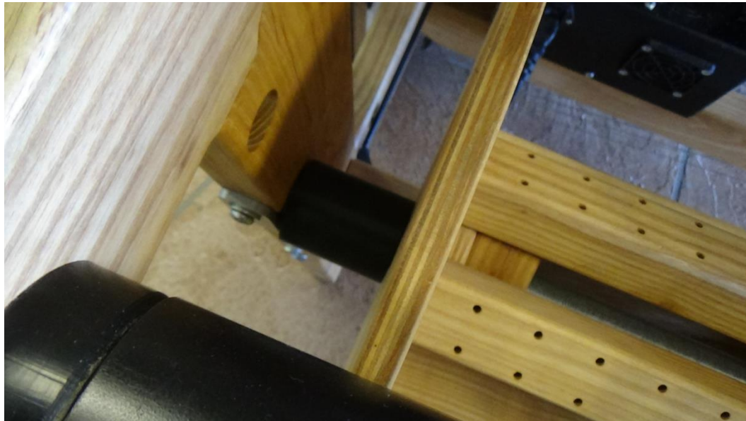
Abbildung 61 - Warp Beam Spacer auf der nicht bremsseitigen Seite
