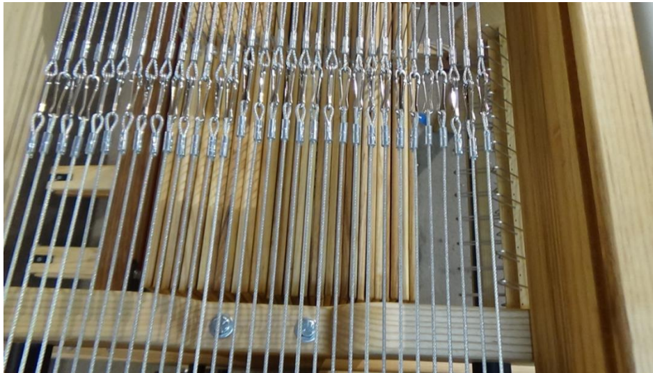
Abbildung 26 - Kabel des oberen Kabelbaums
