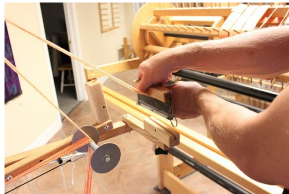
Abbildung 98 - Raddle in die untere Position bringen
