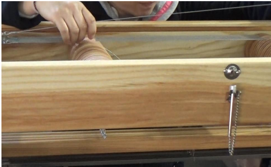
Abbildung 25 - Verlegen der oberen Kabelbaum
