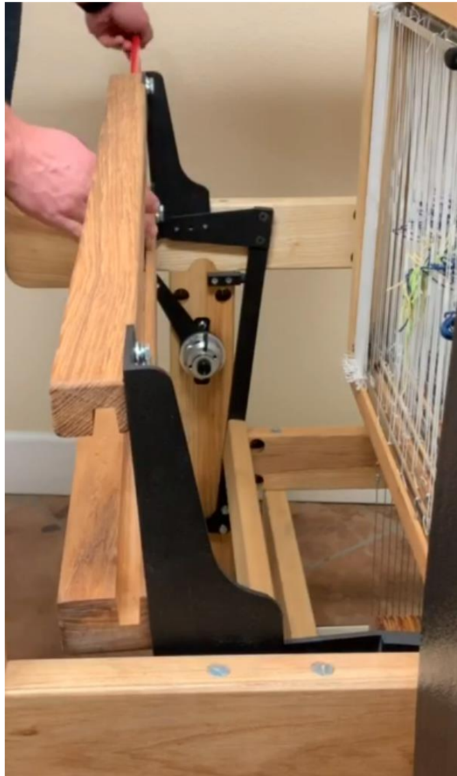
Abbildung 105 - Schieben Sie das Blatt heraus
