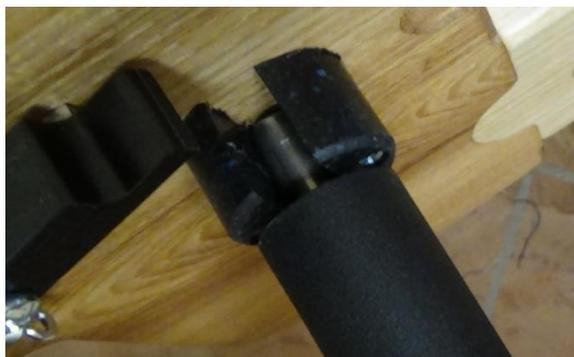
**Figure 53 - Support du rouleau de guidage**
