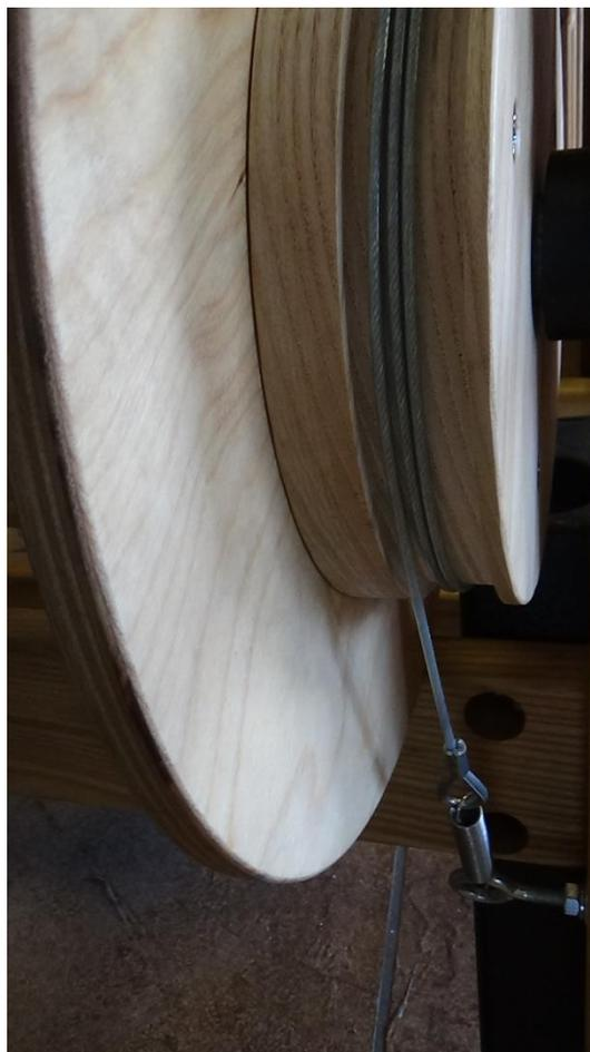
**Figure 64 - Système de tension à l'arrière du métier**
