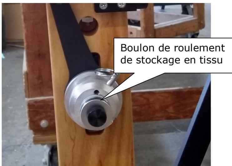
**Figure 41 - Roulement de stockage en tissu**
