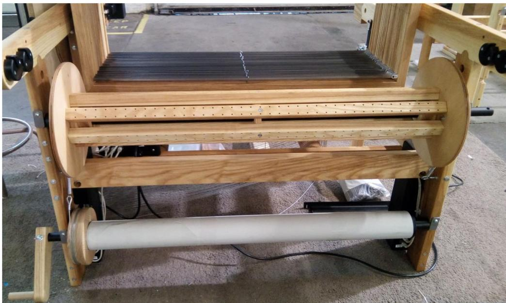
**Figure 67 - Métier à tisser avec deux faisceaux de chaîne**
