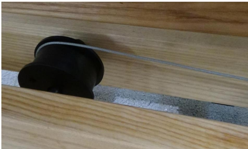
**Figure 32 - Poulie de pédale gauche avec câble**
