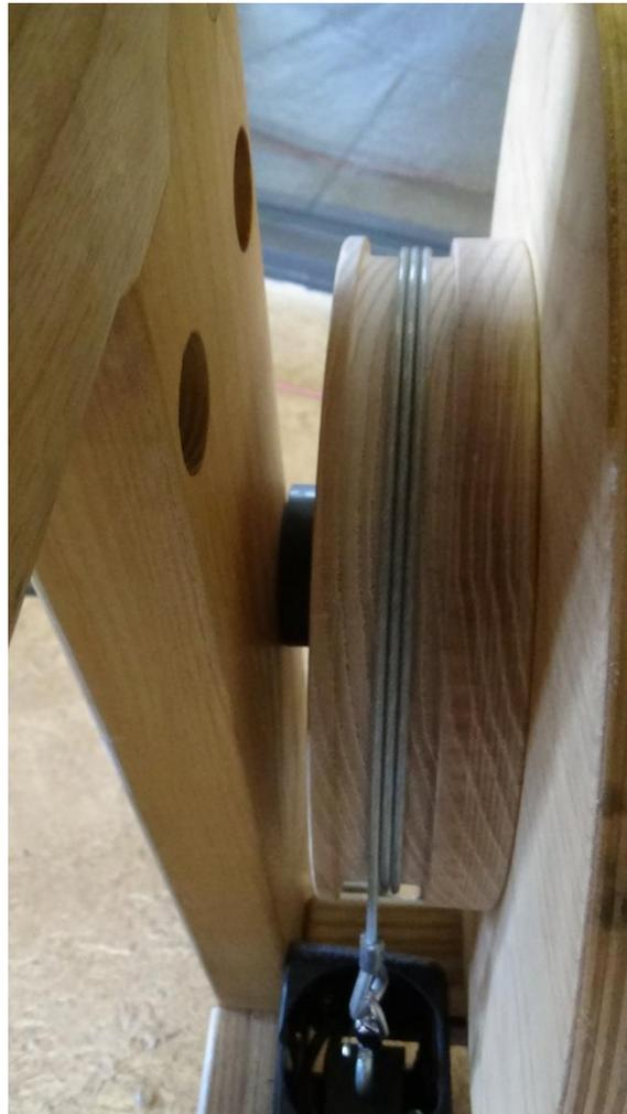
**Figure 65 - Système de tension du métier à tisser intérieur**
