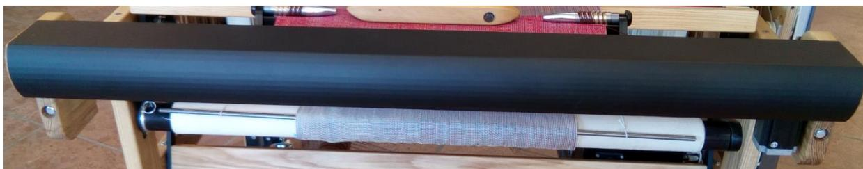
**Figure 59 - Couverture de poutre en tissu**
