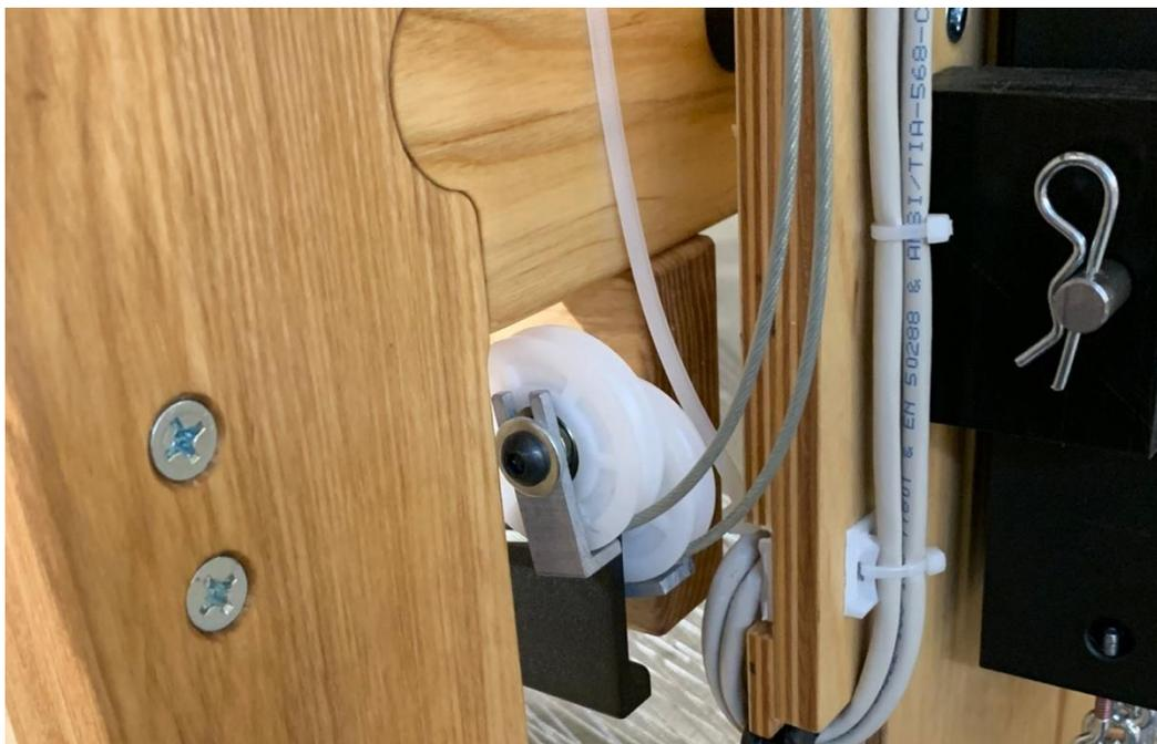
**Figure 23 - Ensemble de poulie de pédale inférieure**
