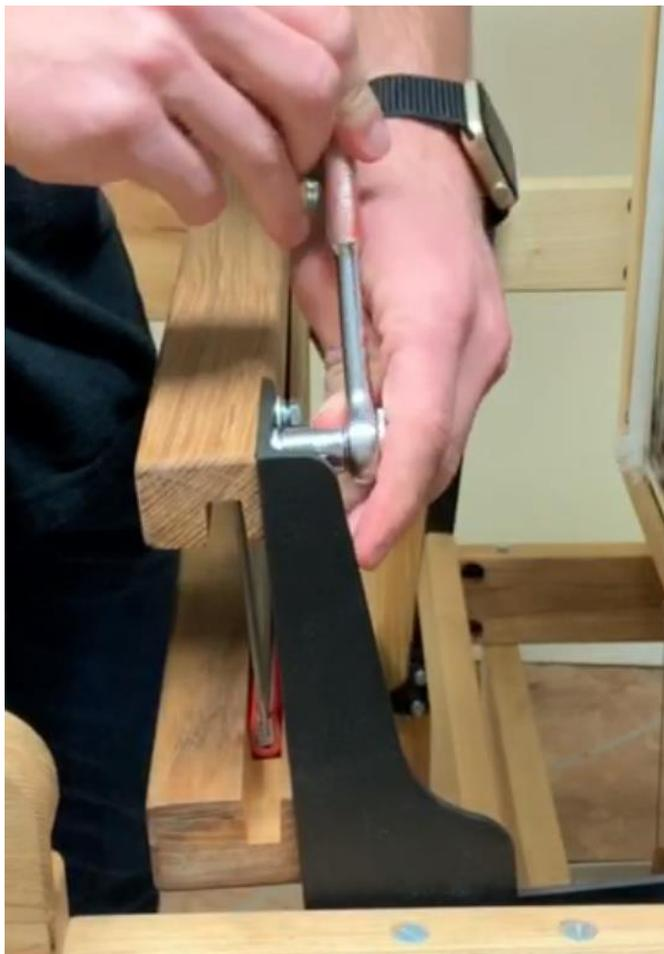
**Figure 103 - Desserer les boulons**
