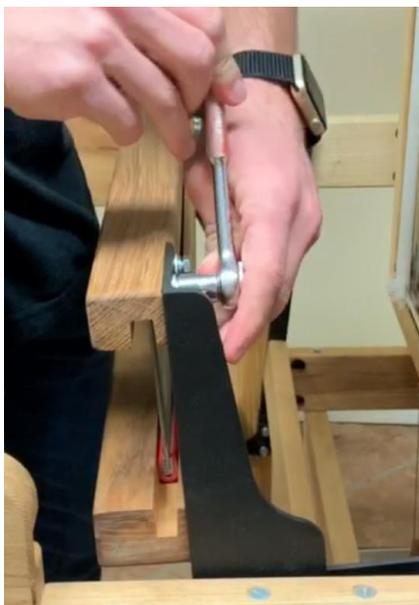
**Figure 46 - Desserrer les boulons**
