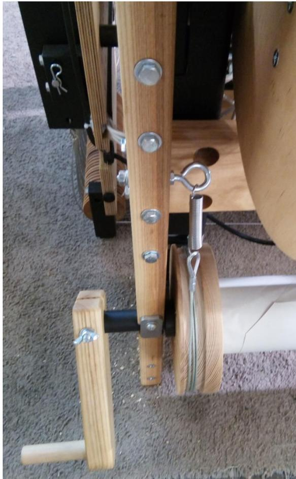
**Figure 66 - Système de tension pour la deuxième poutre**
