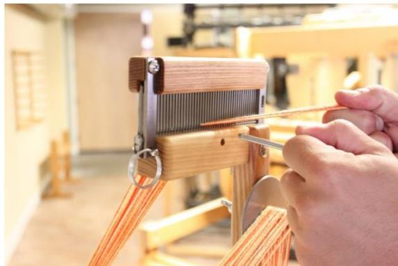
**Figure 97 - Retirez Raddle de la position supérieure**
