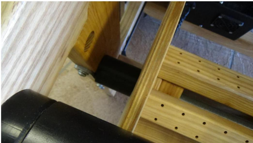
**Figure 61 - Entretoise de faisceau de distorsion côté non-frein**
