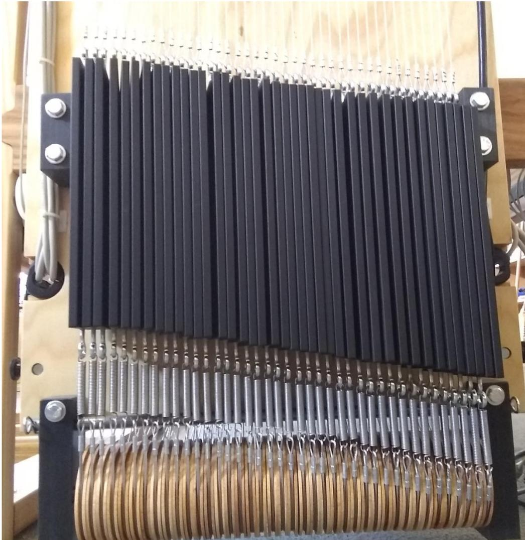
**Figure 28 - Ressorts de câble du faisceau inférieur**
