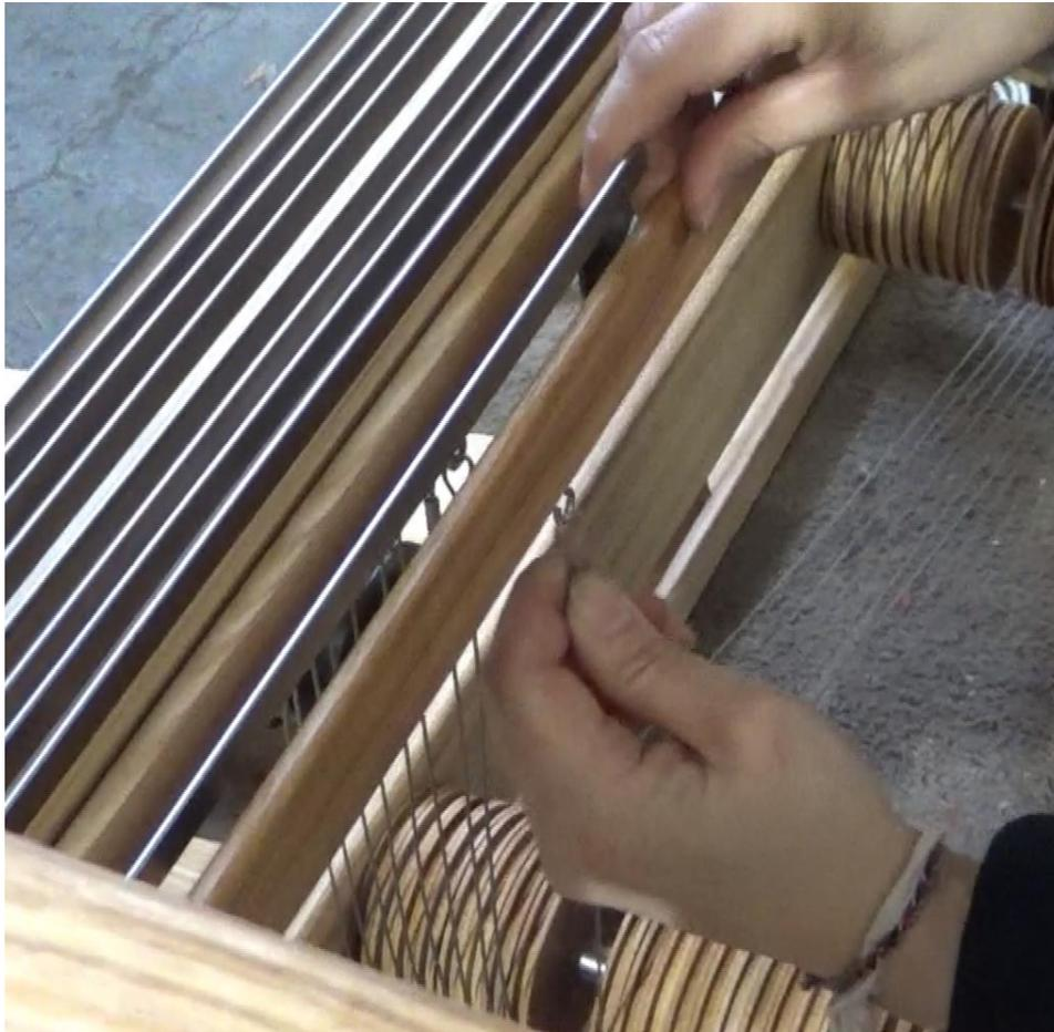
**Figure 29 - Harnais suspendus, câbles inférieurs**
