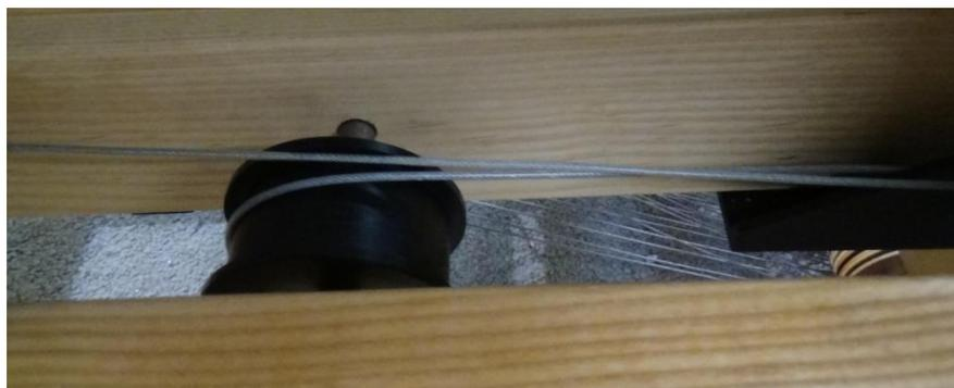
**Figure 34 - Poulie de pédale droite avec câble**
