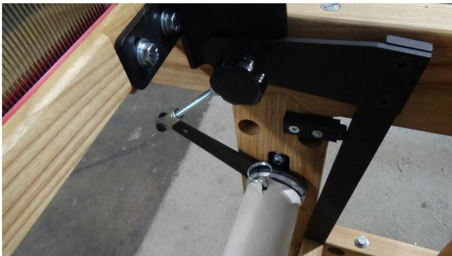
**Figure 44 - Batteur attaché à l'avance de tissu**
