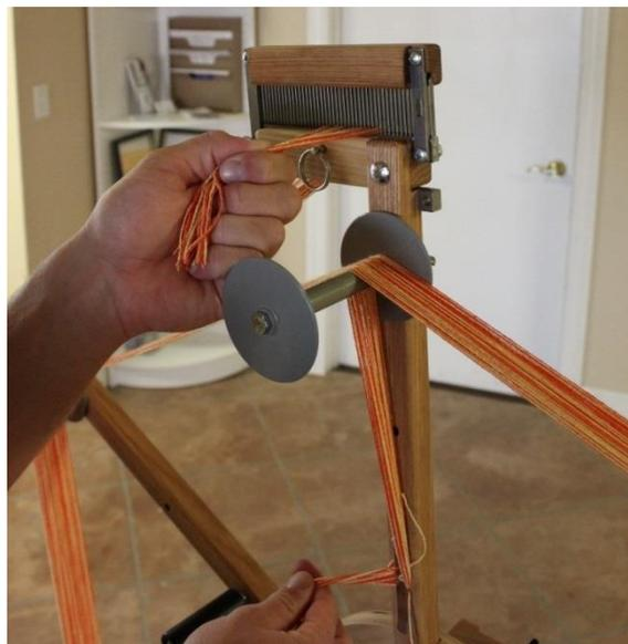
**Figure 96 - Maintenez les fils à Raddle**
