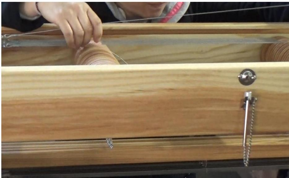
**Figure 25 - Placement des câbles du faisceau supérieur**
