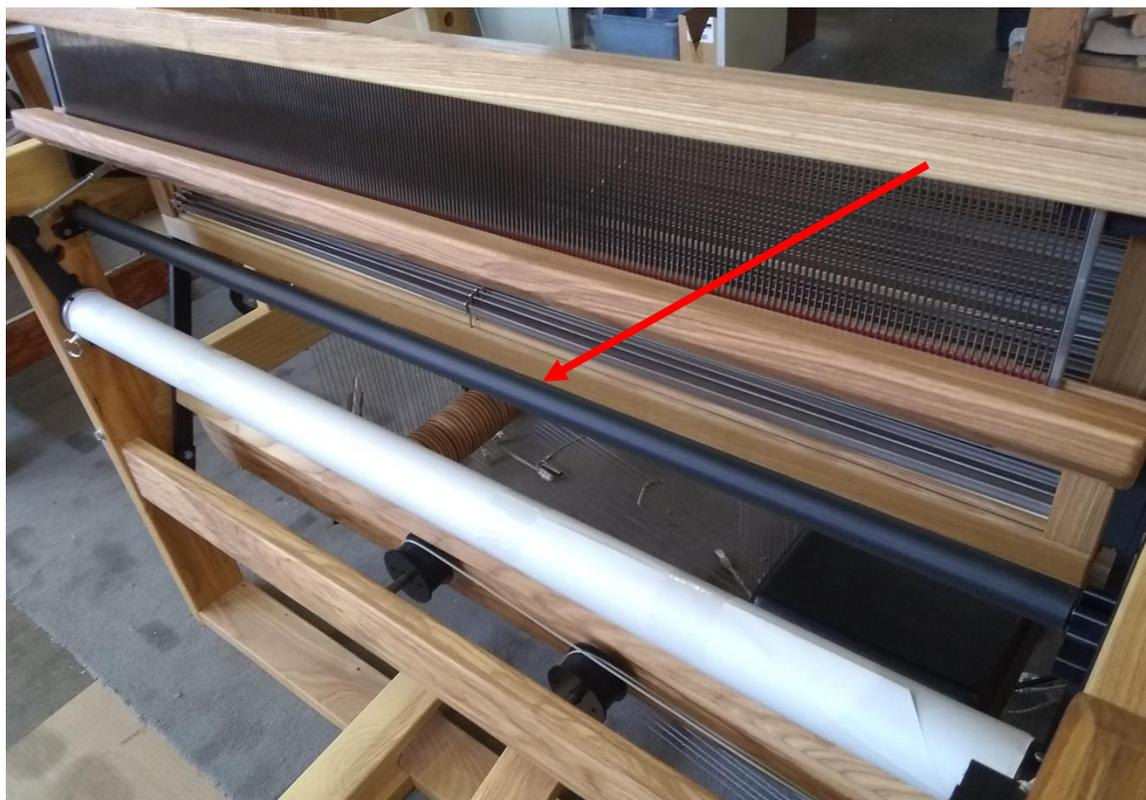
**Figure 52 - Rouleau de guidage du tissu sur le métier**
