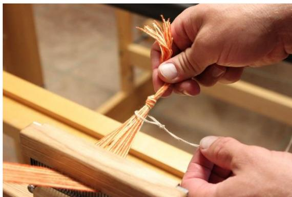
**Figure 99 - Placer la rallonge autour du faisceau de fils**
