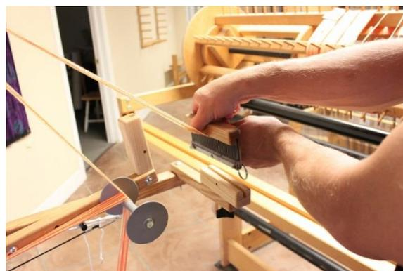
**Figure 98 - Placer le raddle en position basse**
