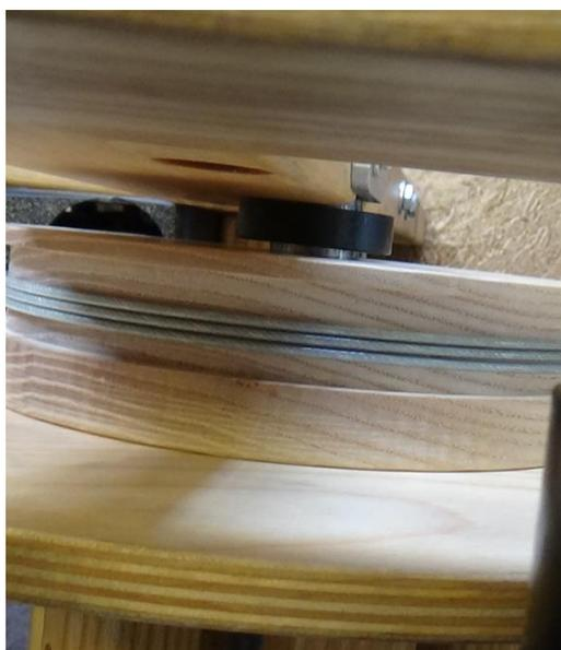
**Figure 62 - Entretoise de faisceau de chaîne côté frein**
