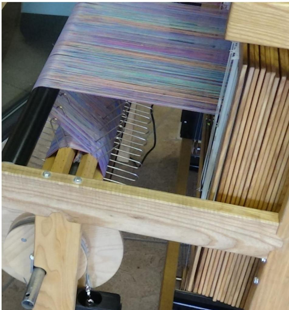
**Figure 85 - Fils de chaîne entrant dans les lisses**
