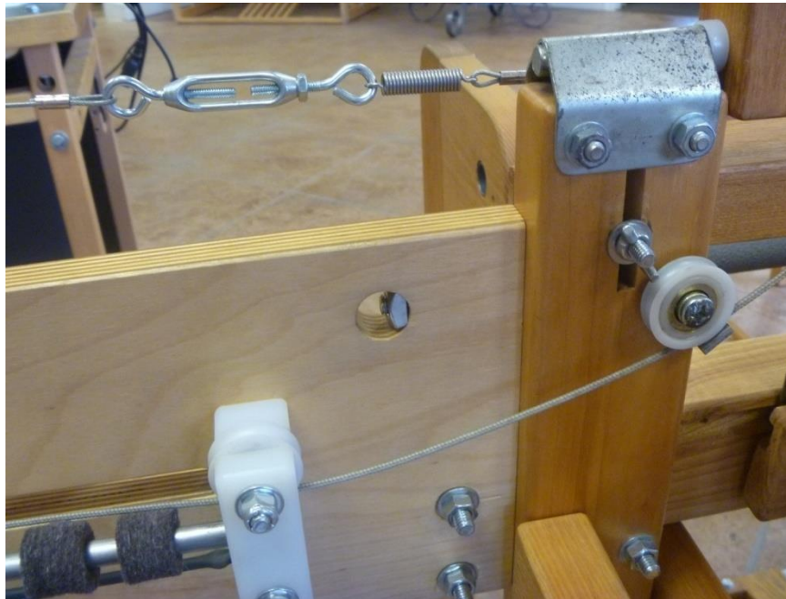
Figura 75 - Enrutamiento del cable Flyshuttle
