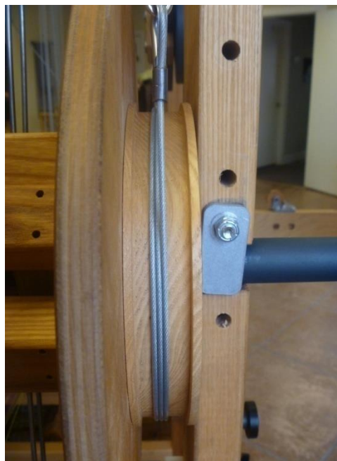
Figura 34 - Cable de tensión alrededor del tambor de freno
