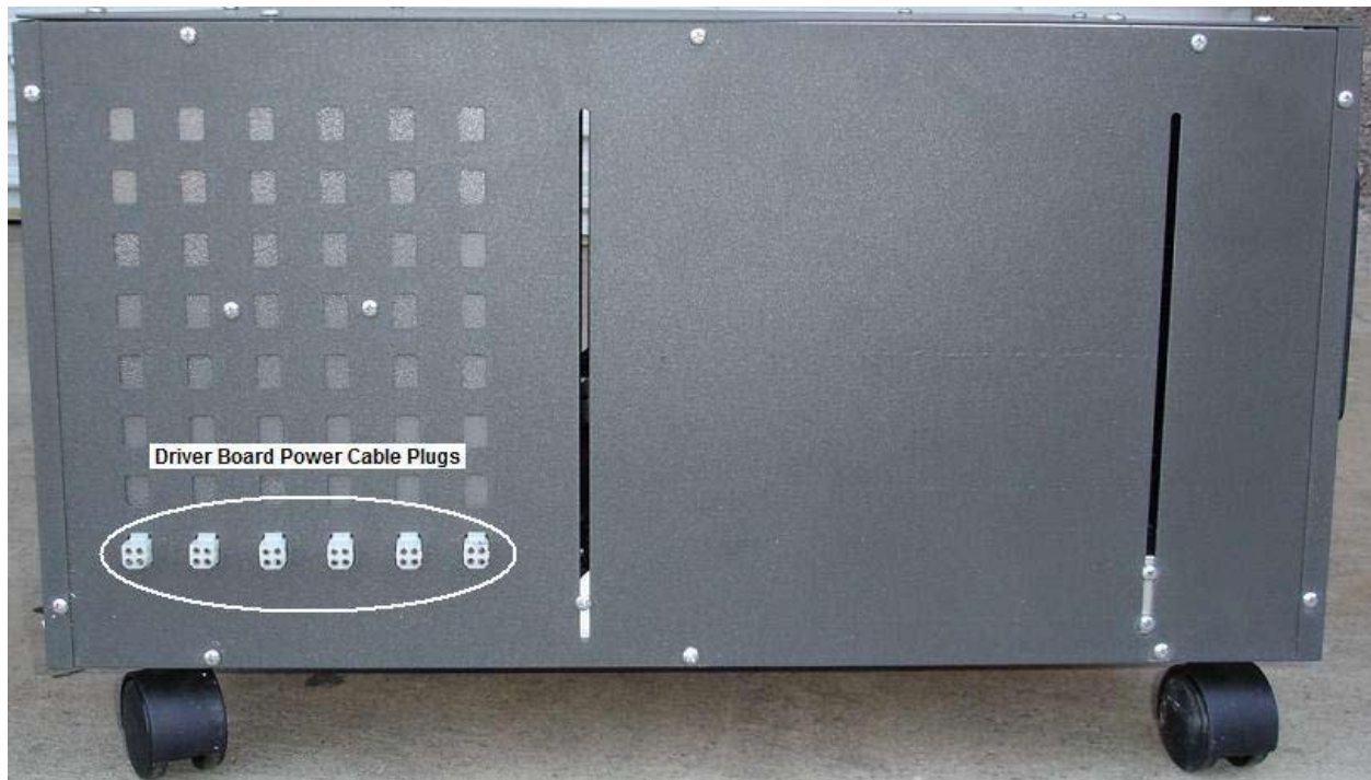
Figura 94 - Caja de control, lado 3 (muestra los enchufes del cable de alimentación de la placa del controlador)
