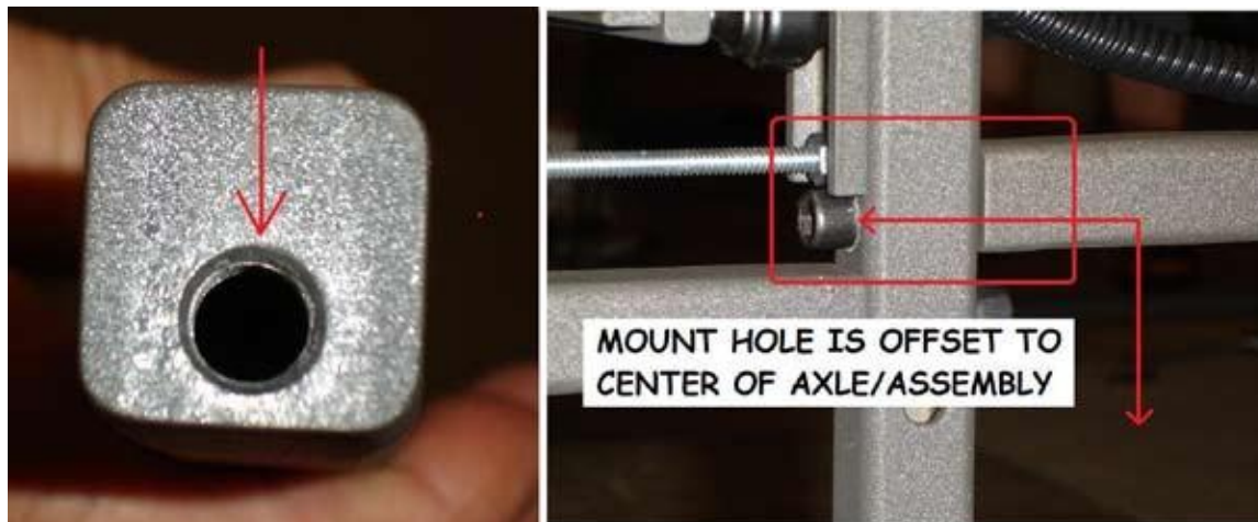
Figura 20 - Orientación del marco lateral a los conjuntos superior e inferior
