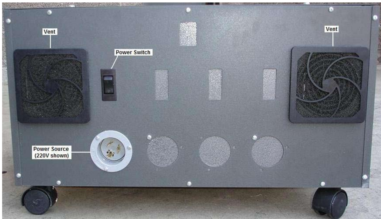
Figura 92 - Caja de control, lado 1 (muestra respiraderos, interruptor de encendido y fuente de alimentación)
