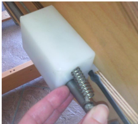
Figura 76 - Resorte y arandela en el cable Flyshuttle
