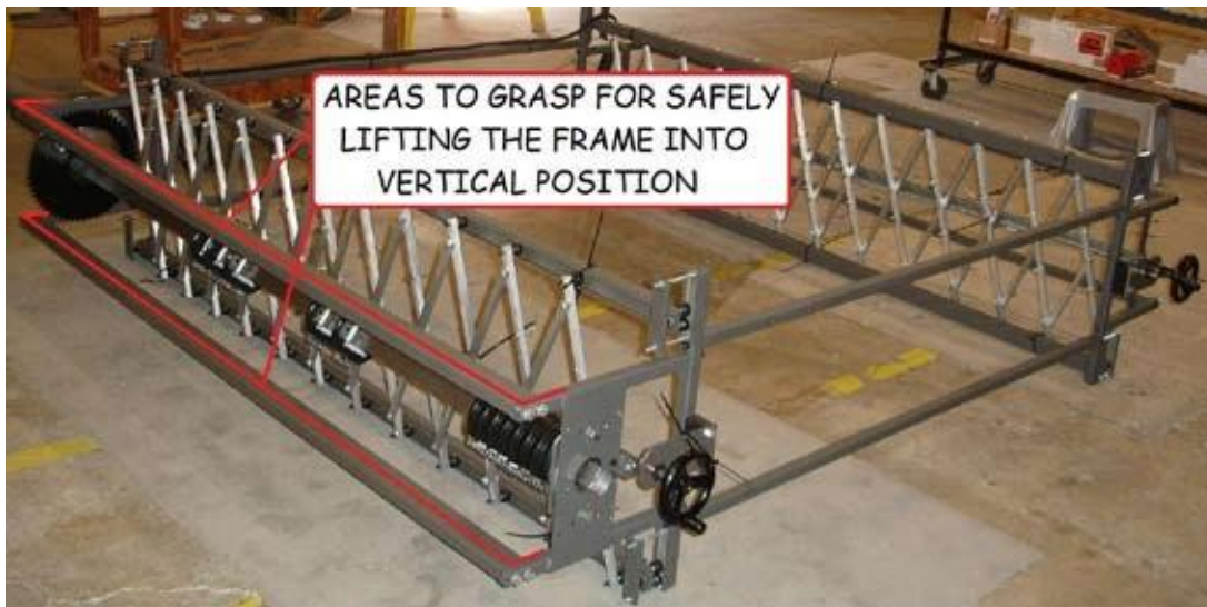
Figura 22 - Áreas de agarre del marco del módulo durante el levantamiento
