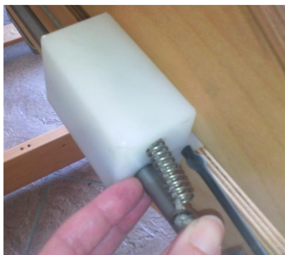
Abbildung 76 - Feder und Unterlegscheibe am Flyshuttle-Kabel
