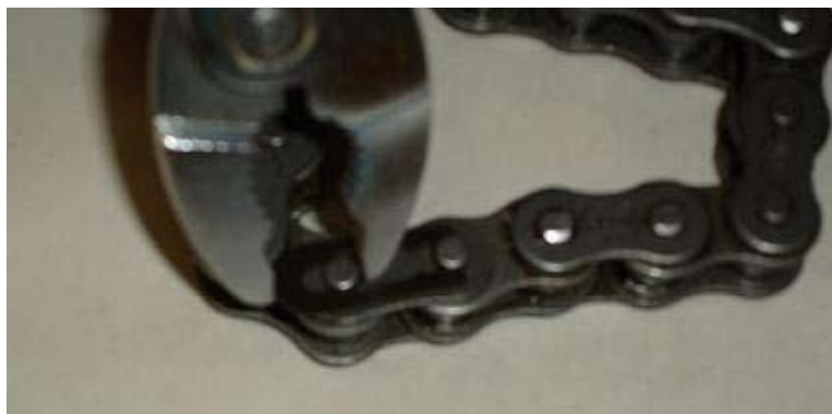
Abbildung 86 - Schließen des Verbindungsgliedclips mit einer Zange
