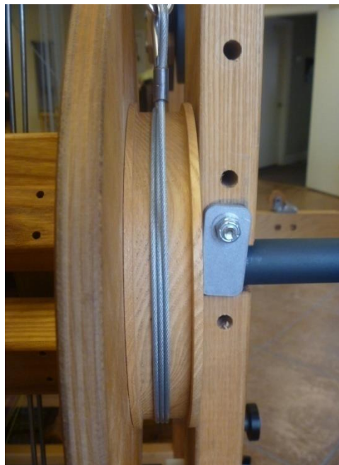
Abbildung 34 - Spannkabel um die Bremstrommel
