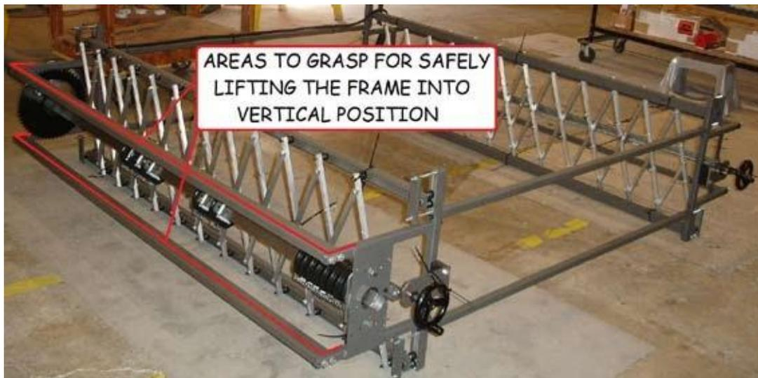
**Figure 22 - Domaines de saisir le module cadre du cours de la lift**
