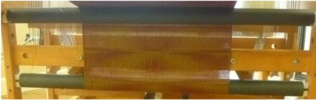
**Figure 42 - Rouleaux du système de rangement en tissu**
