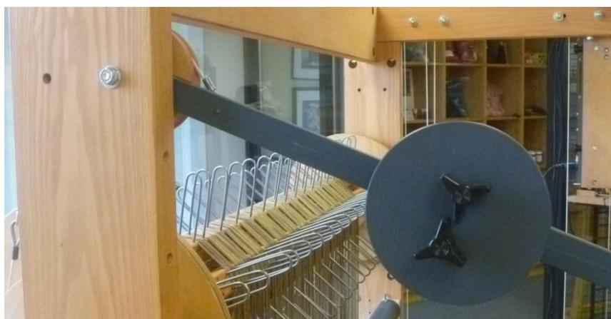
**Figure 37 - Bras de tension avec poids**
