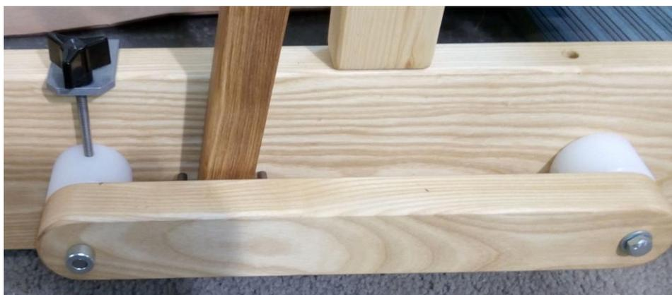
**Figure 50 - Support du batteur pivotant inférieur**
