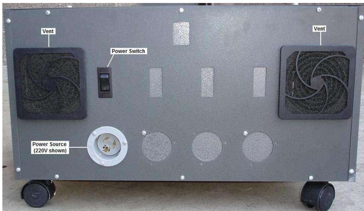
**Figure 92 - Boîtier de commande, côté 1 (montrant les événements, l'interrupteur d'alimentation et la source d'alimentation)**
