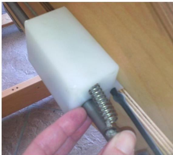
**Figure 76 - Ressort et rondelle sur le cordon Flyshuttle**
