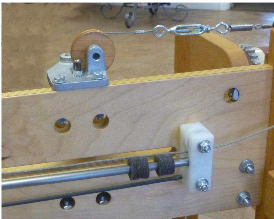
**Figure 77 - Vis de réglage du Flyshuttle**
