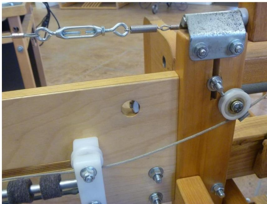
**Figure 75 - Acheminement du cordon Flyshuttle**
