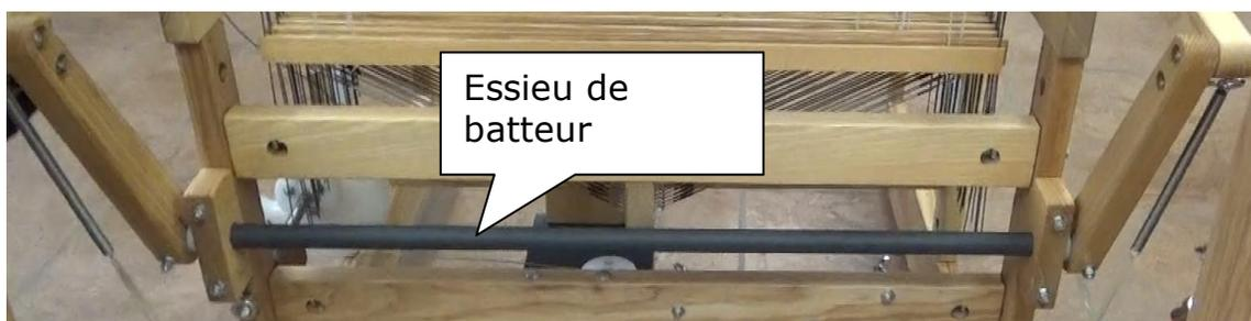
**Figure 64 - Essieu du batteur**
