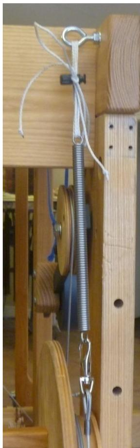
**Figure 35 - Attache de tension supérieure**
