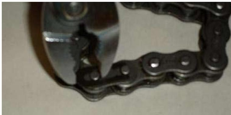
**Figure 86 - Fermeture du clip de liaison avec une pince**
