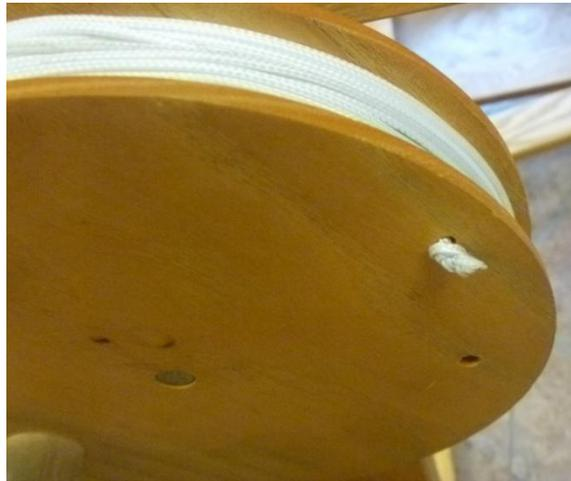
**Figure 46 - Noeud sur le tambour d'enroulement de tissu**
