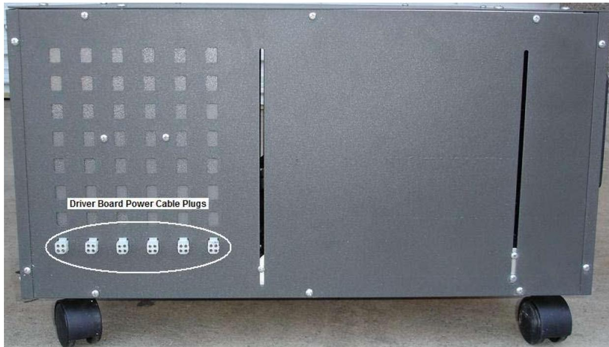
**Figure 94 - Côté du boîtier de commande 3 (montrant les fiches du câble d'alimentation de la carte de commande)**
