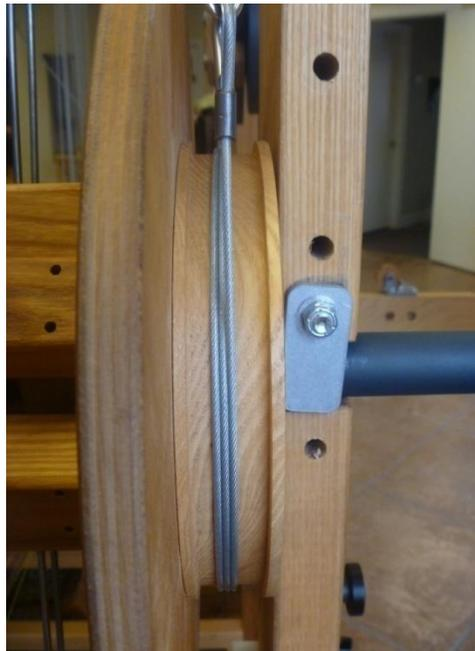
**Figure 34 - Câble de tension autour du tambour de frein**
