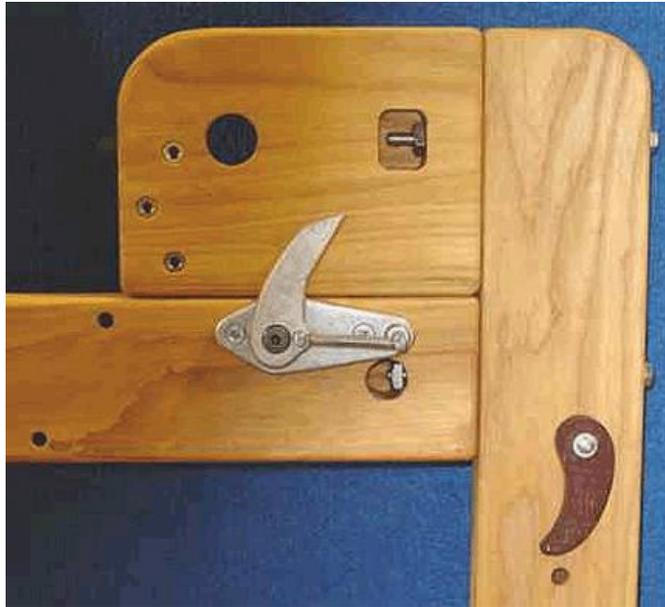
**Figure 39 - Support de poutre en tissu du côté droit**
