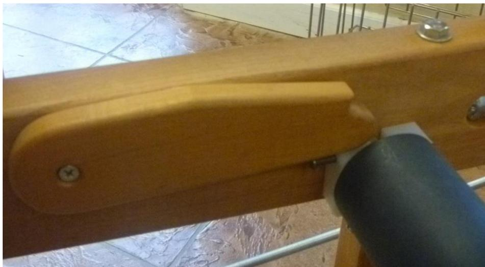
**Figure 58 - Dispositif de retenue du batteur**
