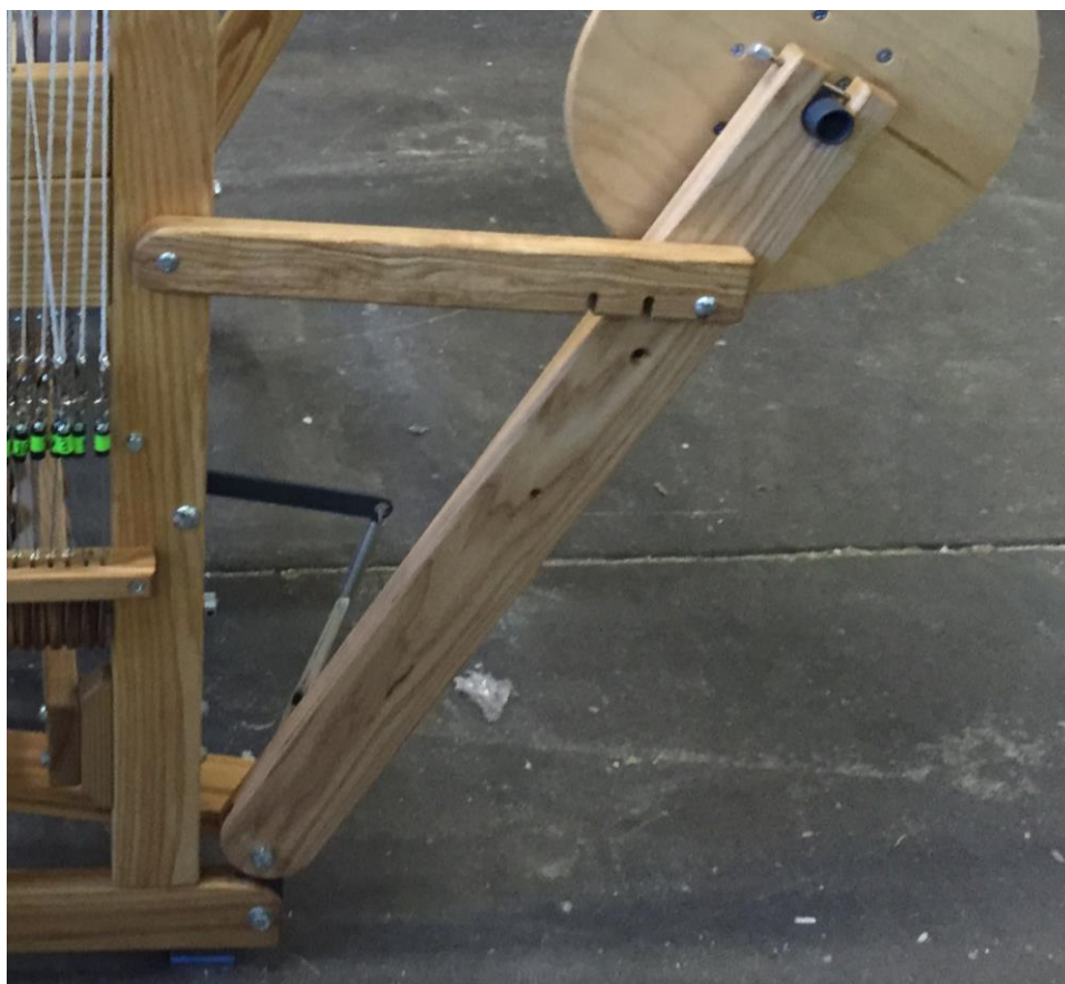
Figura 22 - Brazos de soporte para patas plegables
