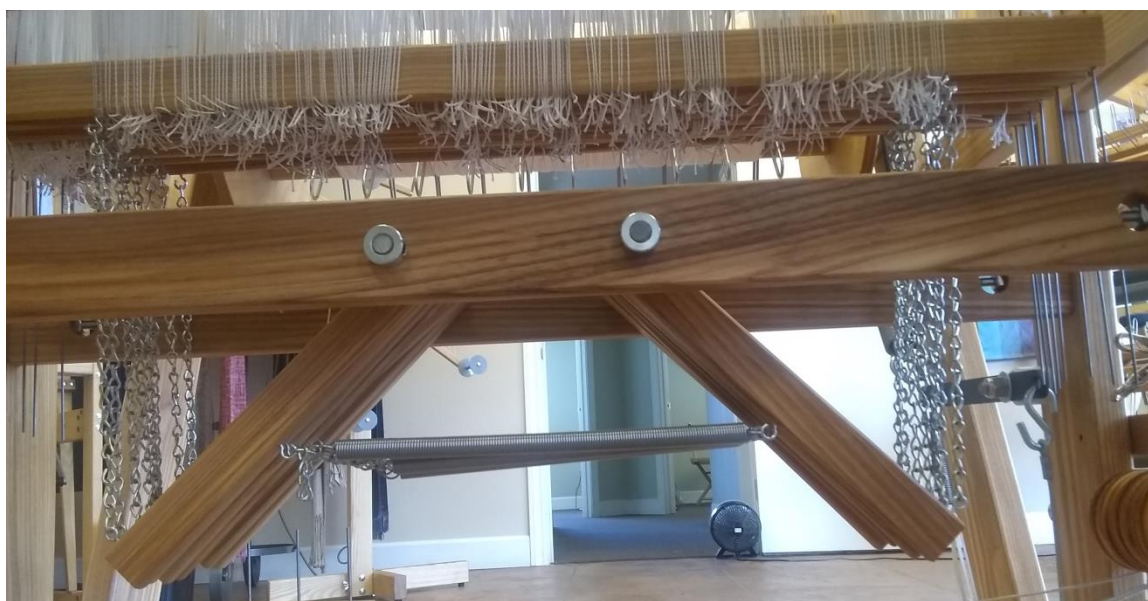
Figura 15 - Palancas de resorte unidas a los arneses
