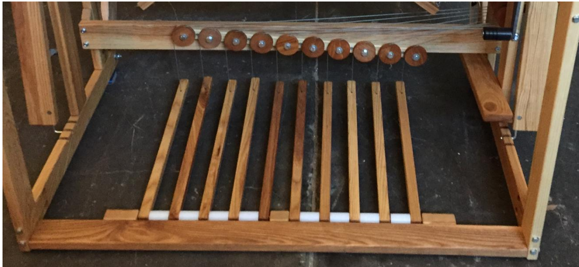
Figura 5 - Miembro frontal con pedales en el telar
