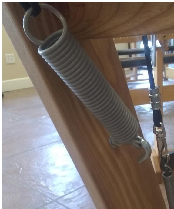
Abbildung 25 - Feder für Bremsseil
