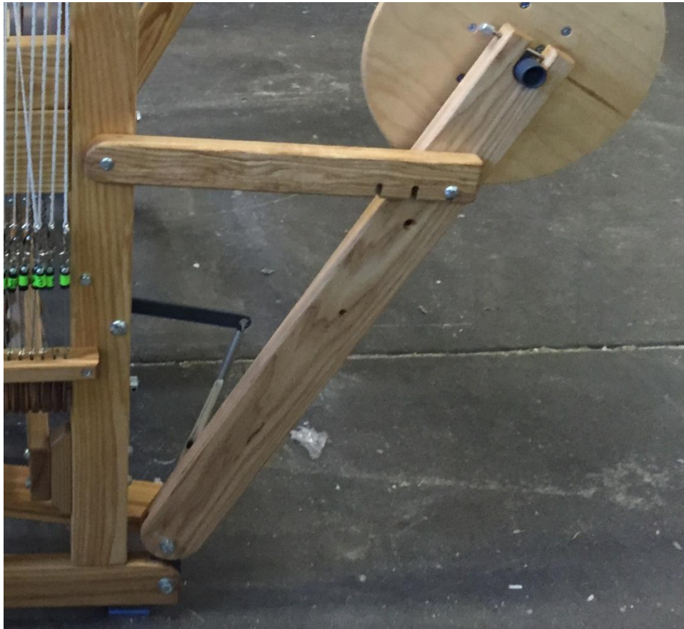
Abbildung 22 - Stützarme zum Zusammenklappen der Beine
