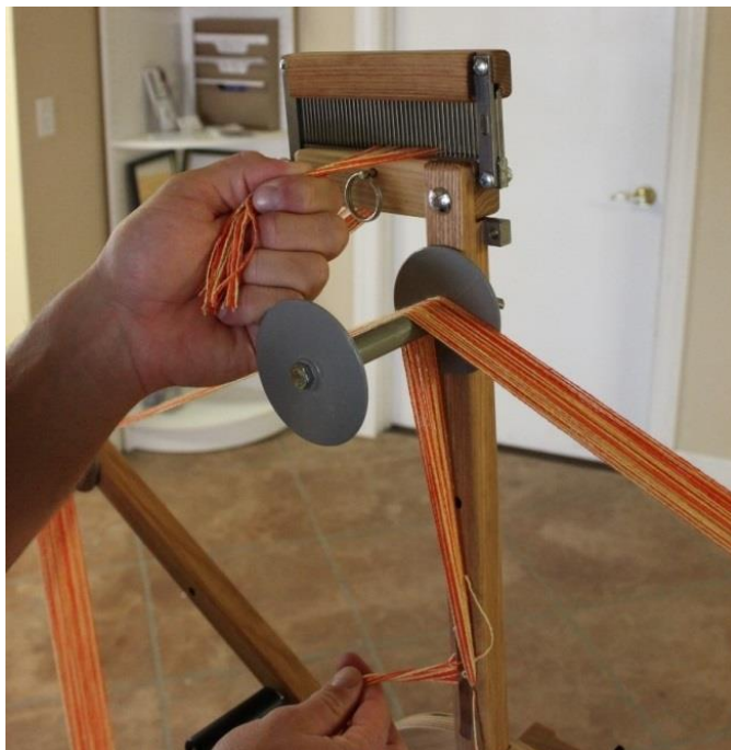
Abbildung 46 - Gewinde am Raddle halten
