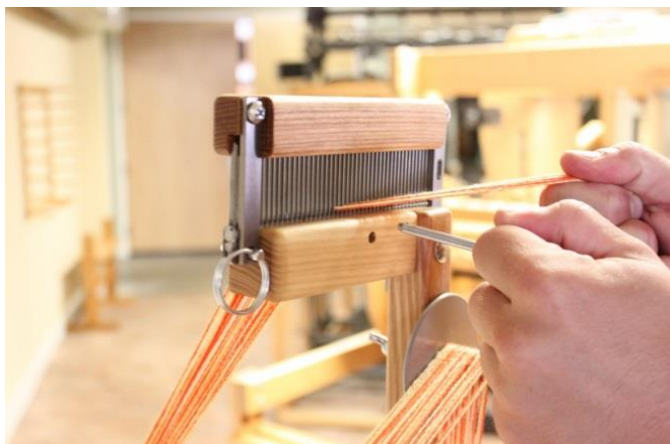
Abbildung 47 - Raddle aus der oberen Position entfernen
