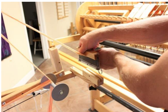
Abbildung 48 - Platzieren Sie Raddle in der unteren Position
