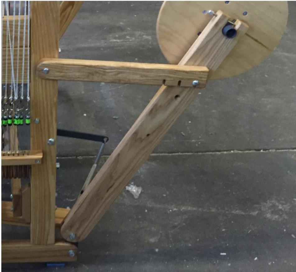
**Figure 22 - Bras de support pour les jambes repliables**
