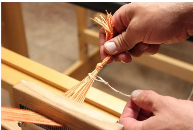
**Figure 49 - Placer la rallonge autour du faisceau de fils**
