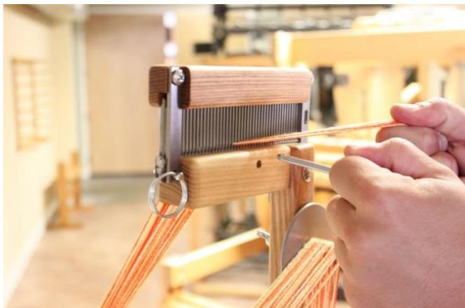
**Figure 47 - Retirez Raddle de la position supérieure**
