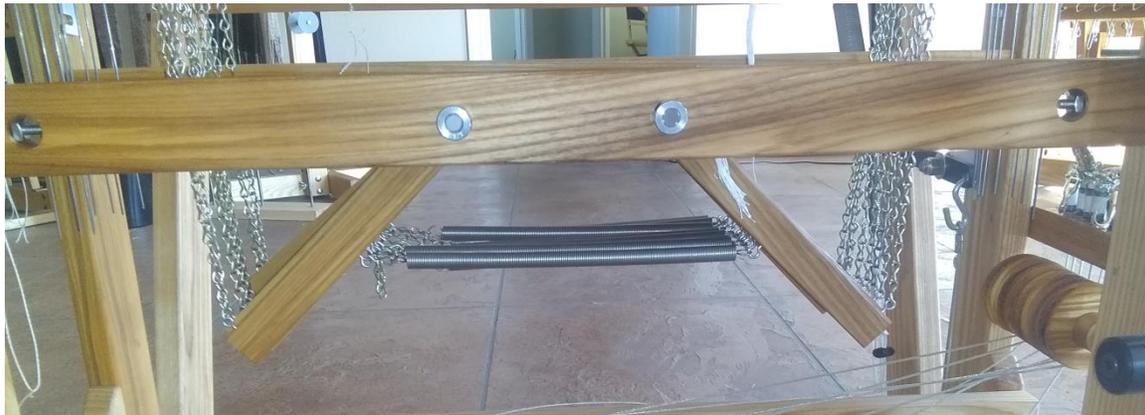
**Figure 7 - Ensemble de support de levier à ressort**
