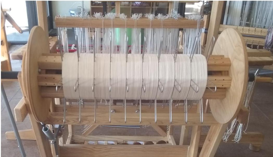
**Figure 23 - Poutre sectionnelle sur métier à tisser**
