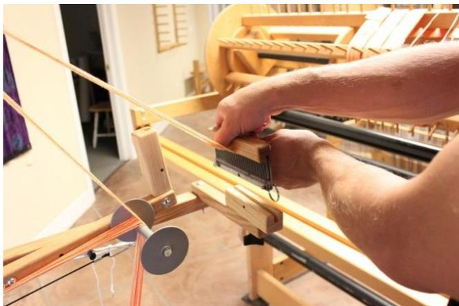
**Figure 48 - Placer le raddle en position basse**
