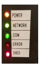
2) Warten Sie, bis der Webstuhl hochgefahren ist. Dies kann dauern bis zu mehreren Minuten. Sobald der Webstuhl fertig ist, werden nur die Anzeigen "Power" und "Network" angezeigt. Die Netzwerklampe kann grün oder rot sein.
