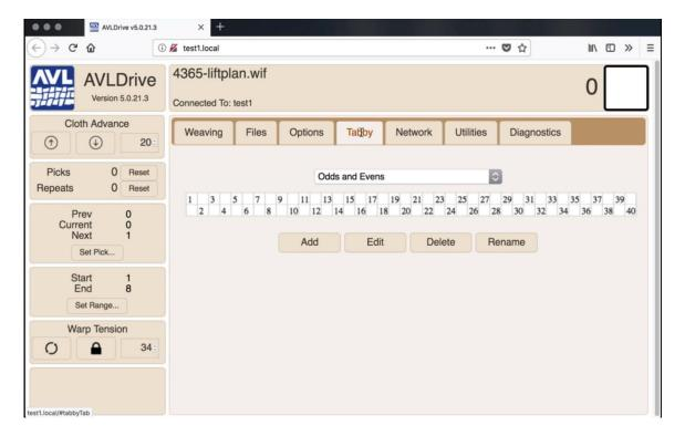
Wählen Sie im Dropdown-Menü den Tabby aus, der für Ihr Threading verwendet werden soll. Es stehen mehrere Standardeinstellungen zur Verfügung.
