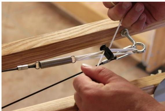
**Figura 13 - Ajuste la tensión de desconexión**
