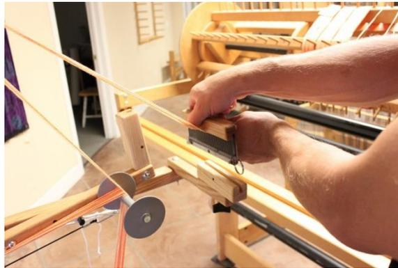
**Figura 19 - Coloque el Raddle en la posición inferior**
