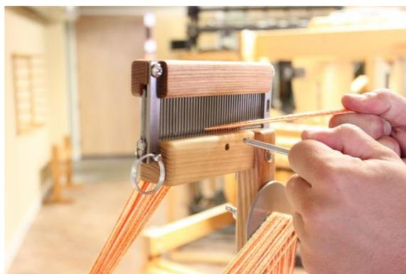
**Figura 18 - Retire Raddle de la posición superior**
