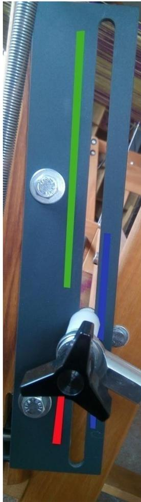
**Figura 38 - Soporte del batidor**
