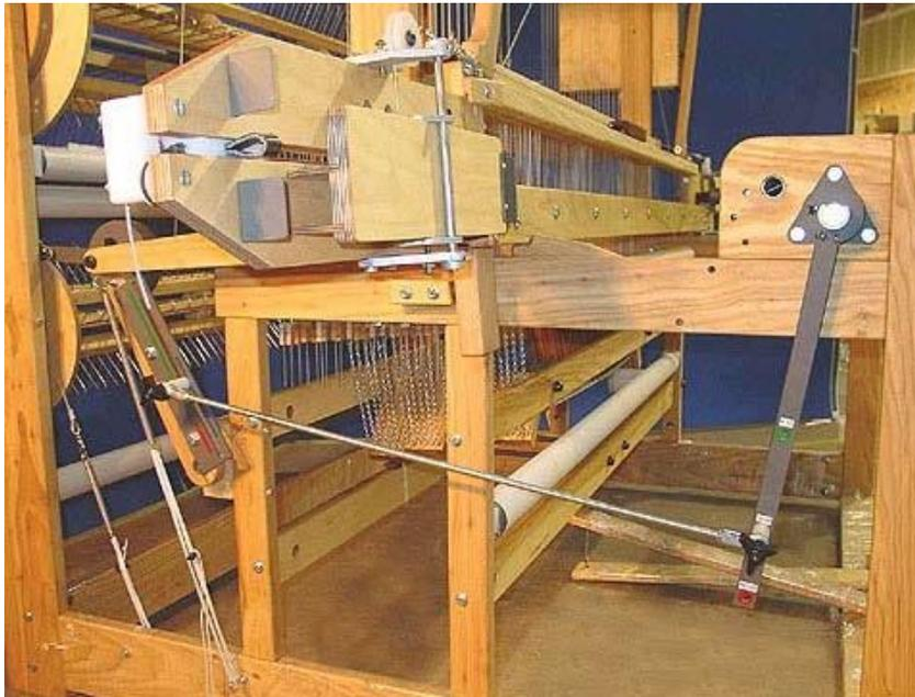
**Figura 36 - Batidor de techo con avance automático**
