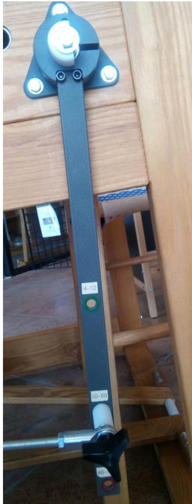
**Figura 37 - Brazo de avance automático**
