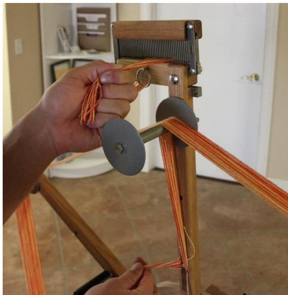
**Figura 17 - Mantenga los hilos en Raddle**
