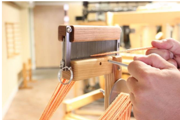
Abbildung 18 - Raddle aus der oberen Position entfernen
