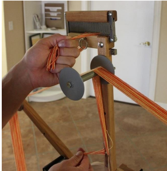
Abbildung 17 - Halten Sie die Gewinde am Raddle
