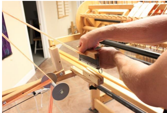
Abbildung 19 - Platzieren Sie Raddle in der unteren Position
