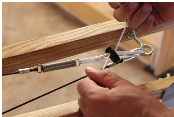
Figure 13 - Ajuster la tension de déroulement
