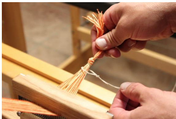
Figure 20 - Placer la rallonge autour du faisceau de fils
