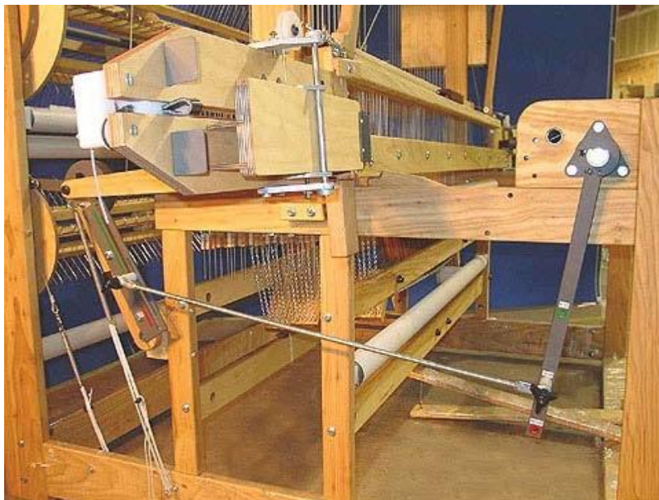
Figure 36 - Batteur aérien avec avance automatique
