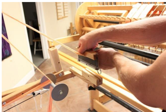
Figure 19 - Placer le raddle en position basse
