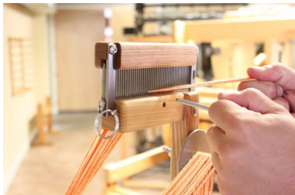
Figure 18 - Retirez le raddle de la position supérieure
