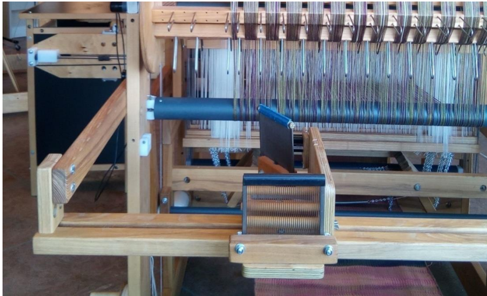
Figura 127 - Caja de tensión en telar
