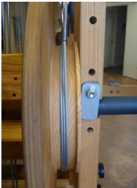
Figura 69 - Cable de tensión alrededor del tambor de freno
