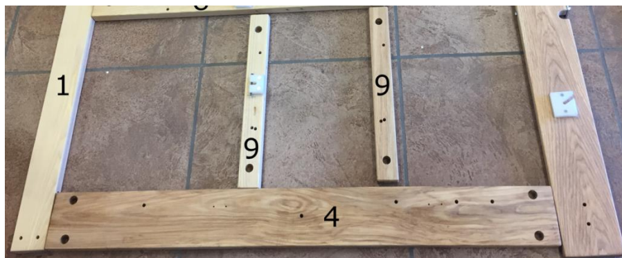
Figura 17 - Marco lateral parcialmente completado
