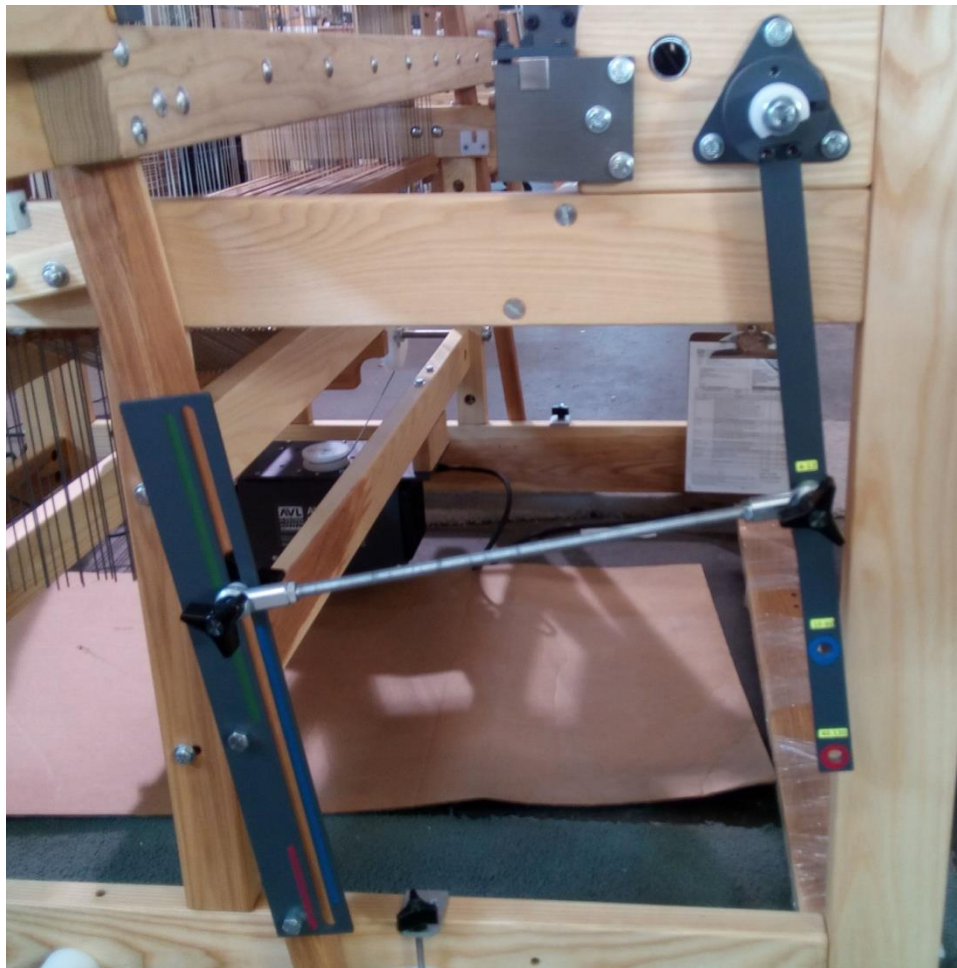
Figura 129 - Avance automático en telar
