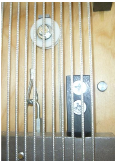
Figura 49 - Cable de la placa deslizante de Dobby a la palanca de resorte
