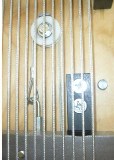
**Abbildung 49 - Dobby-Gleitplatte zum Federhebelkabel**
