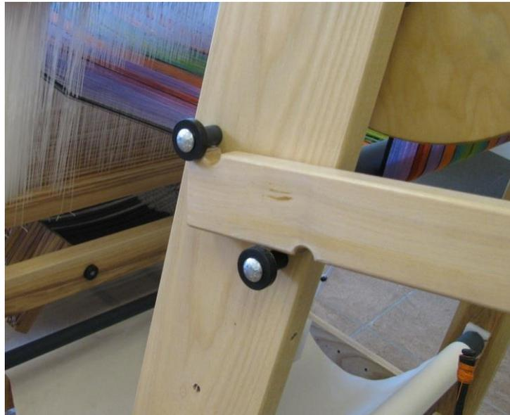
**Abbildung 125 - Einfügen von Schiene und Halterung**
