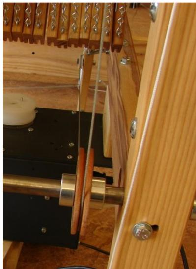
**Abbildung 50 - Kabel der Rücklaufrolle**
