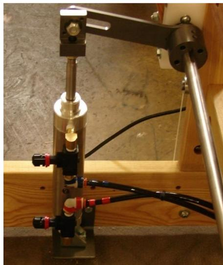
**Abbildung 149 - Luftzylinder**
