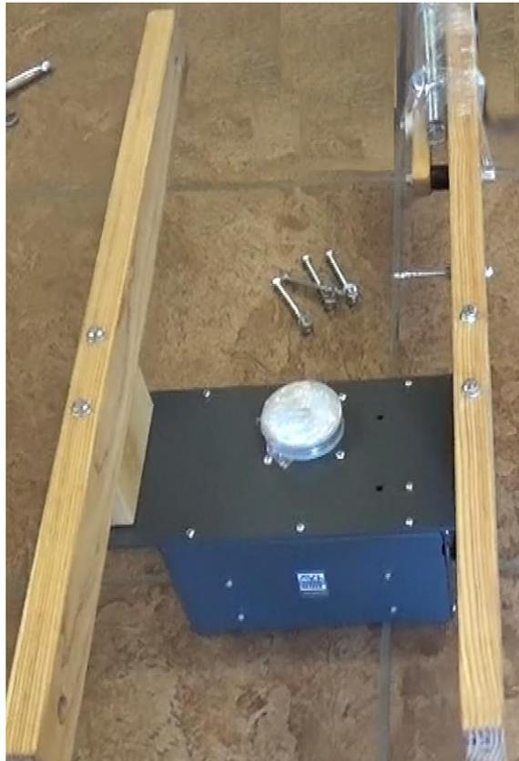
**Abbildung 30 - An den Stützen befestigter E-Lift**
