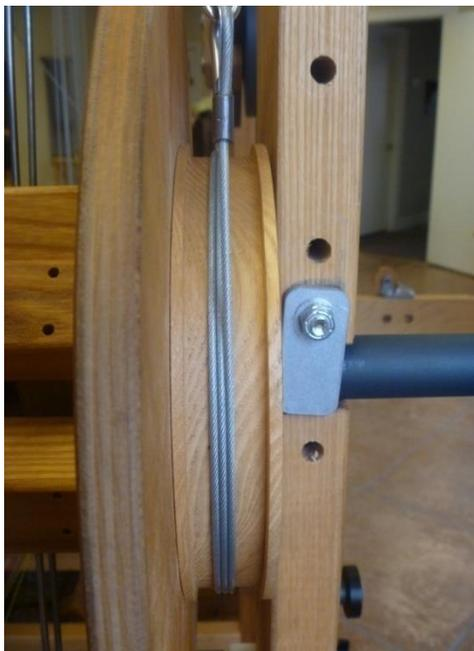
**Abbildung 69 - Spannkabel um die Bremstrommel**
