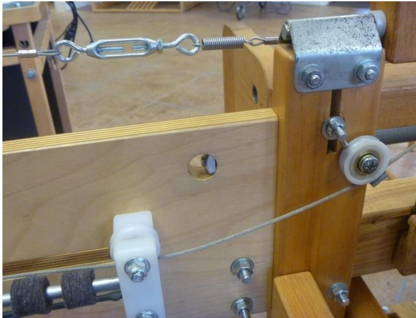
**Abbildung 113 - Routing Flyshuttle Cord**
