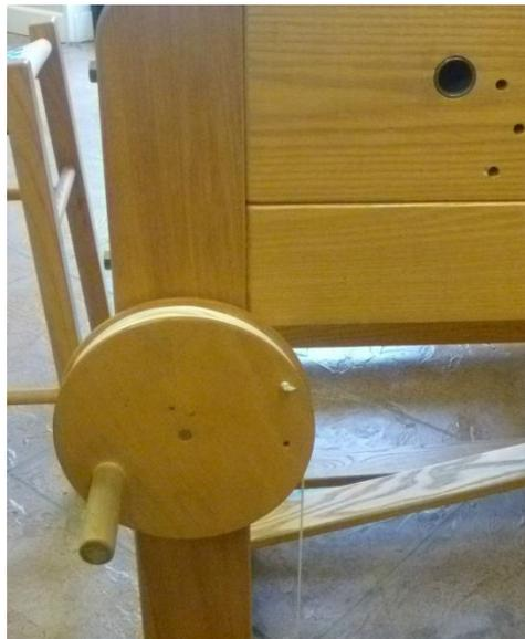
**Abbildung 78 - Stoffaufnahmetrommel**
