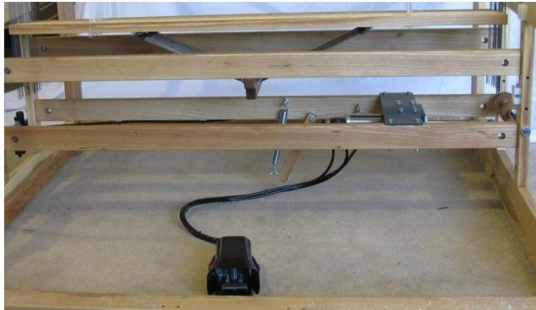
**Abbildung 137 - A-Lift- Fußpedal**
