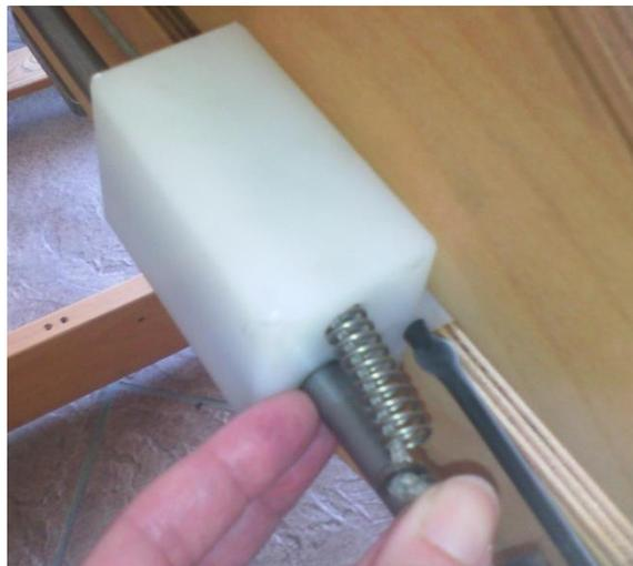
**Abbildung 114 - Feder und Unterlegscheibe am Flyshuttle- Kabel**
