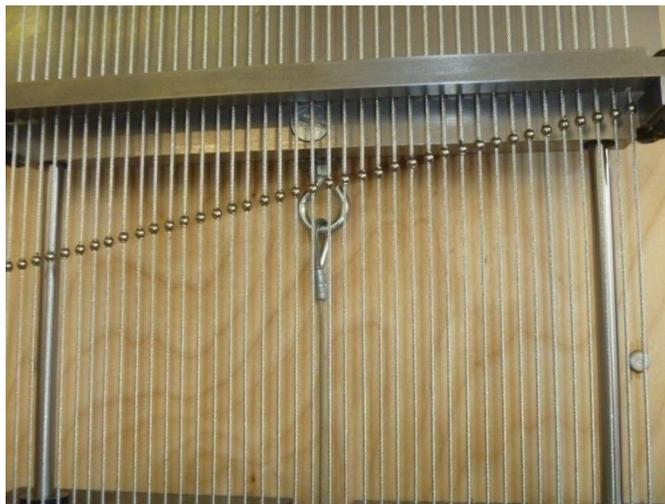
**Abbildung 48 - Augenschraube der Gleitplatte**
