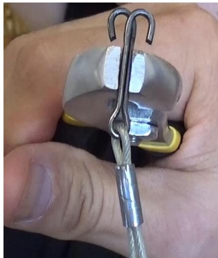
**Abbildung 54 - Mit einer Zange geöffneter Clip**
