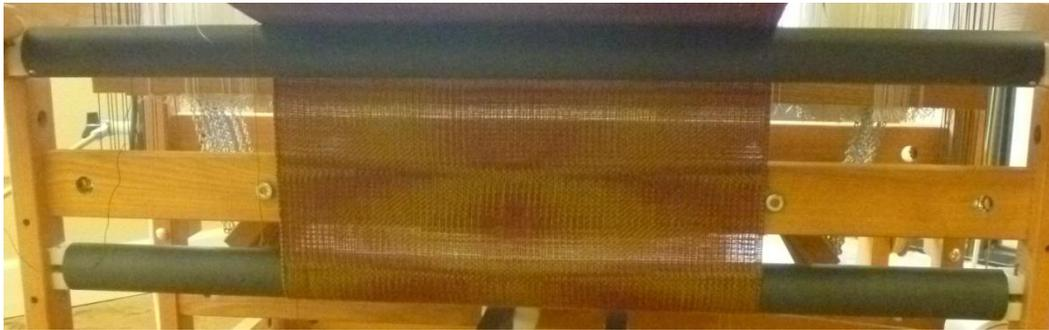
**Abbildung 77 - Rollen des Stoffspeichersystems**
