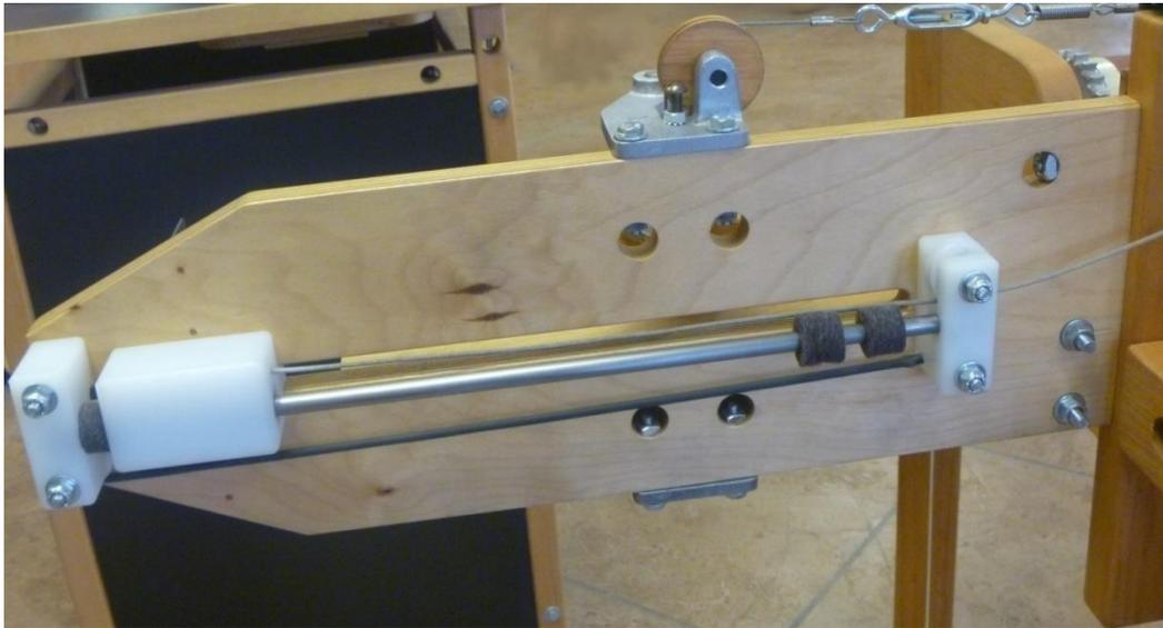
**Abbildung 110 - Flyshuttle Box von hinten**
