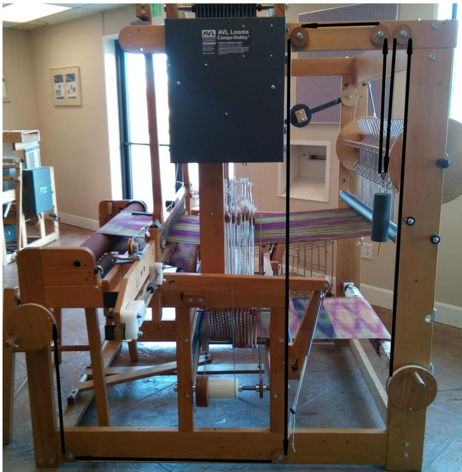
**Abbildung 80 - Verlegen des Stoffaufnahmekabels**
