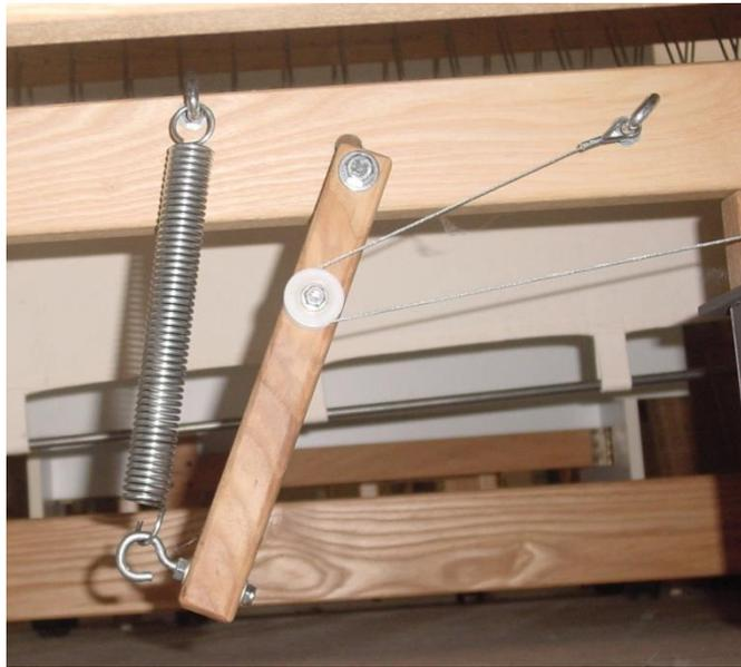
**Abbildung 51 - Federhebel mit E-Lift**
