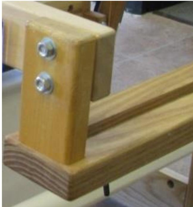
**Abbildung 124 - Anbringen von Schienen- und Montagearmen**
