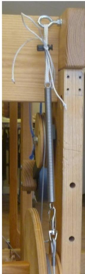
**Abbildung 70 - Oberzugverbindungs - up**
