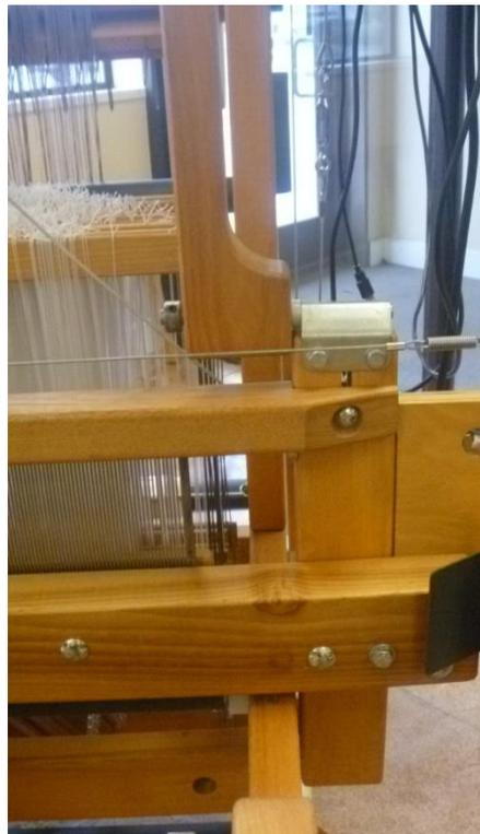
**Abbildung 99 - Überkopf-Schlagpfosten**
