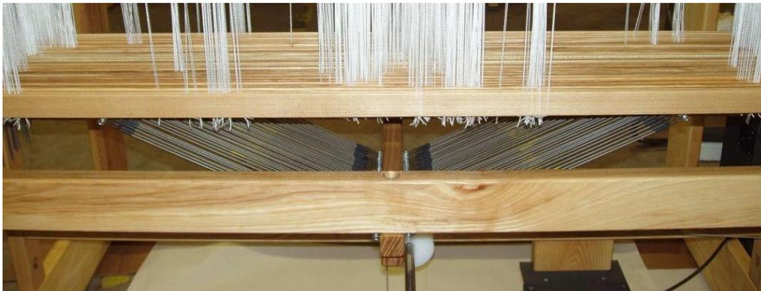
**Abbildung 34 - 32/40 Kabelbaumfedersystem**
