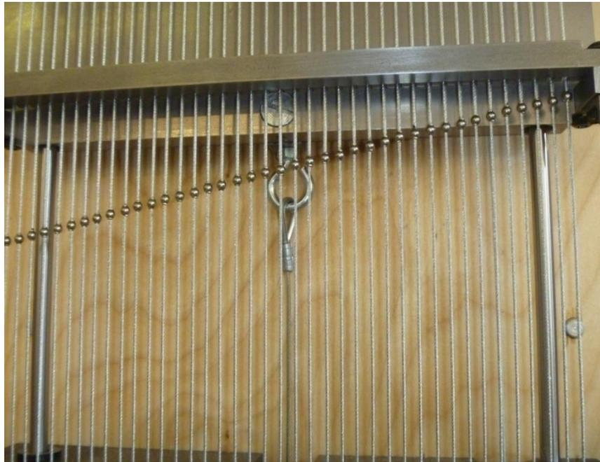
**Abbildung 141 - Augenschraube und Kabel der Gleitplatte**
