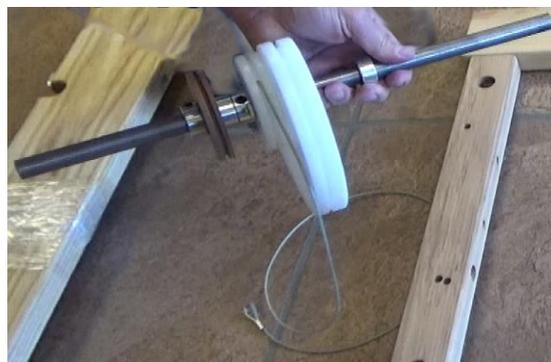
**Abbildung 19 - Dobby Cam Assembly für E-Lift**
