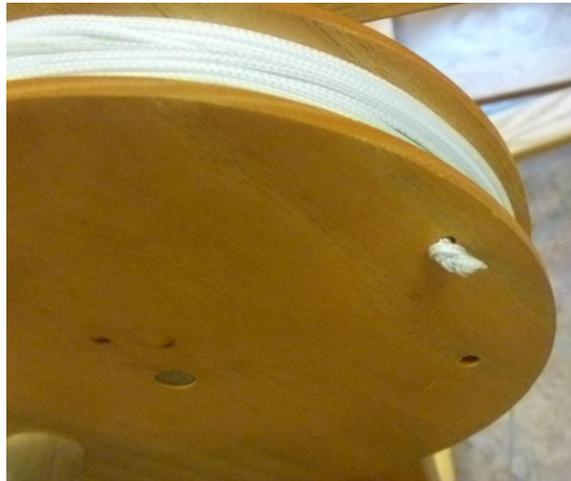
**Abbildung 81 - Knoten auf Stoffaufnahmetrommel**
