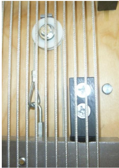
Figure 49 - Plaque coulissante Dobby au câble du levier à ressort
