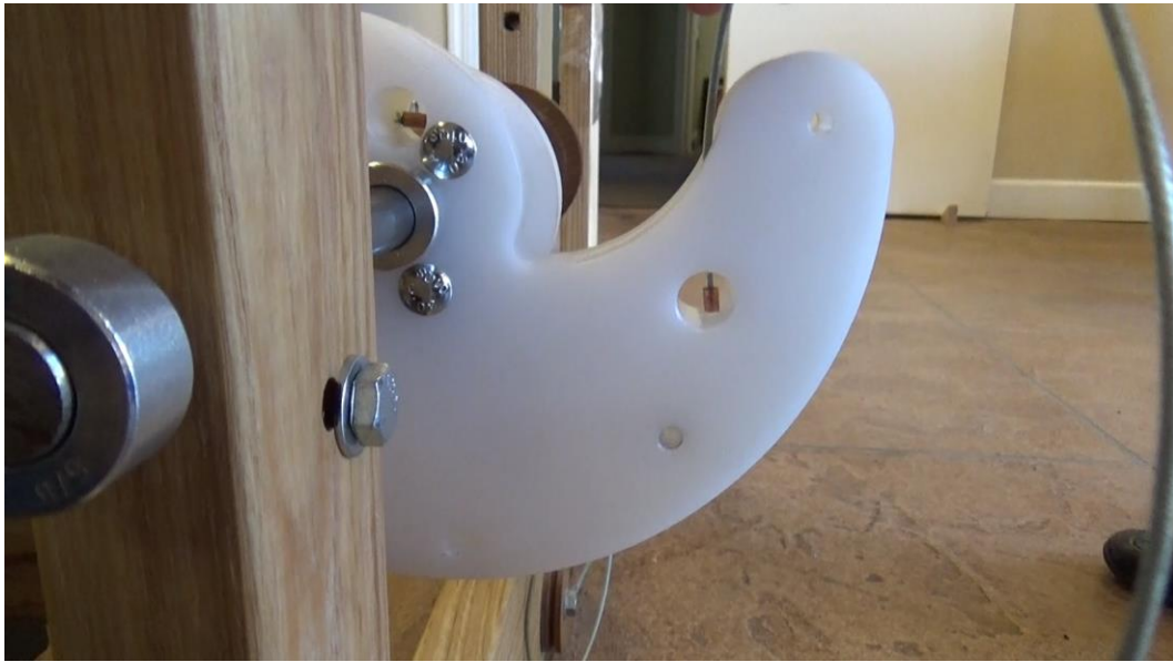
Figure 52 - Câble dans la came Nautilus
