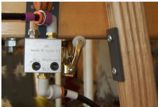
Figure 147 - Soupape de sécurité
