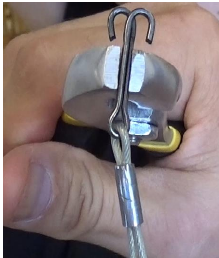
Figure 54 - Clip ouvert avec une pince
