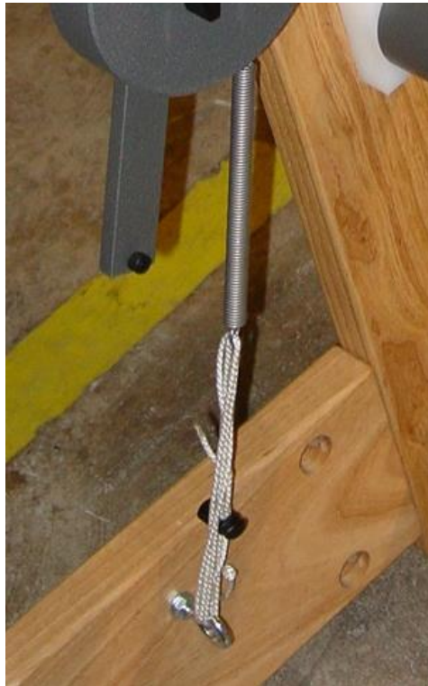
Figure 67 - Cordon de tension du faisceau inférieur
