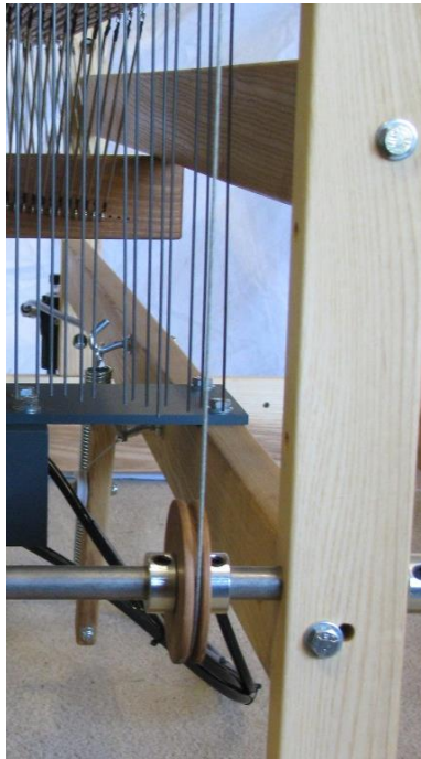
Figure 139 - Positionnez la poulie
