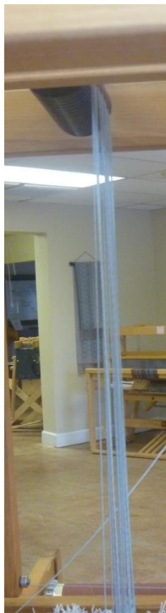
Figure 57 - Câbles de harnais suspendus au métier à tisser
