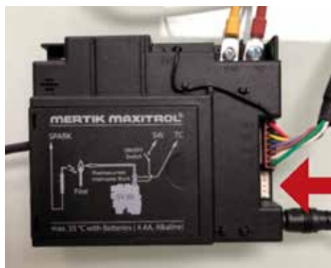
Image 1 : Emplacement de la connexion du faisceau de l'interrupteur mural indiqué par la flèche
