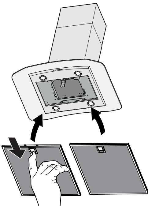
Remettez en place les filtres à graisse de l'auvent de la hotte.
