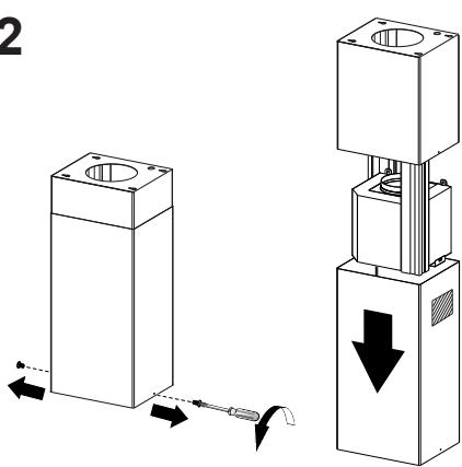
Dévissez les deux vis qui fixent la section inférieure de la cheminée et détachez-la du châssis inférieur.
