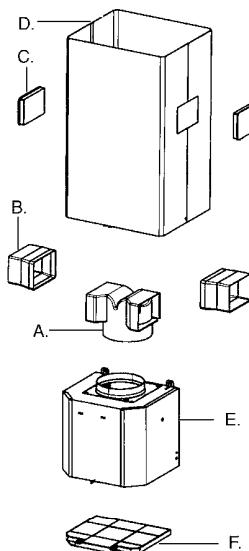
L'installation sans conduit nécessite une **Trousse de conversion pour installation sans conduit** dont les éléments sont représentés à la **FIGURE 12**.
