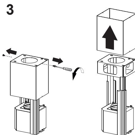
Dévissez les deux vis qui fixent la section supérieure de la cheminée et détachez-la du châssis supérieur.
