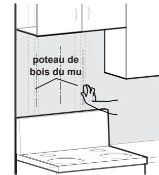
3. Déterminez l'emplacement de l'accroche de fixation de l'appareil principal : identifiez le centre d'installation de la hotte, puis tracez une ligne médiane verticale. Déterminez l'emplacement de l'accroche avec comme référence le point le plus bas du fond de l'armoire du dessus. Marquez ensuite les emplacements de perçage. La distance entre le point le plus bas du fond de l'armoire et le centre du crochet est 16"(405mm).
