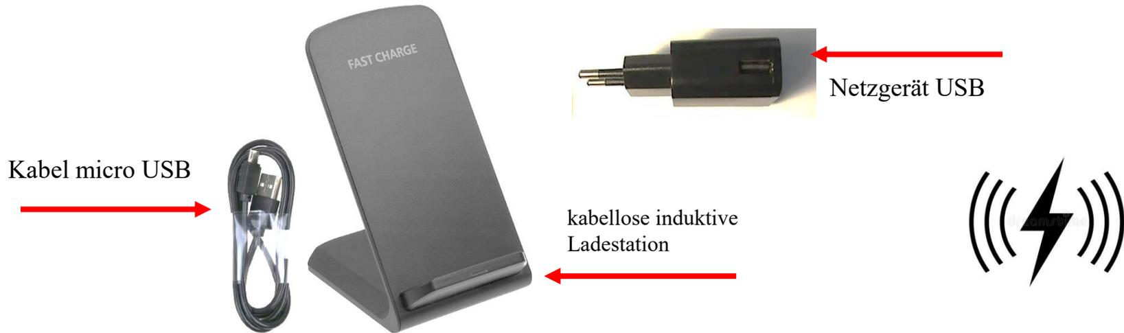
Schließen Sie das USB-Ladegerät über ein USB-Kabel an die kabellose Ladestation an. Das Gerät LifeTel sollte auf der Ladestation platziert werden (wie im Bild unten), eine rote LED sollte leuchten, um anzuzeigen, dass das Gerät geladen wird. Wenn die Diode LED grün leuchten, ist das Gerät vollständig aufgeladen.
