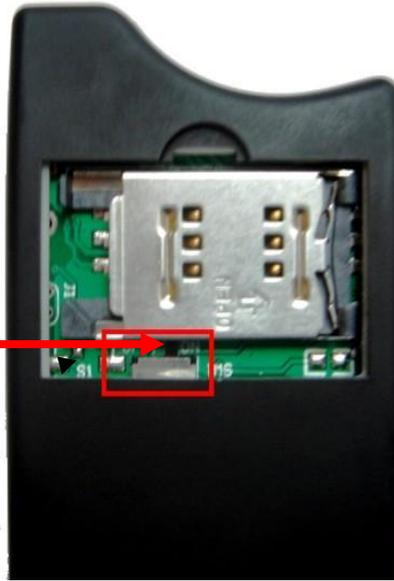
Bevor Sie das Gerät laden, müssen Sie den Batteriesicherheitsschalter auf ON (EIN) stellen. Der Batteriesicherheitsschalter dient nur zum sicheren Transport der Batterie im Gerät.
