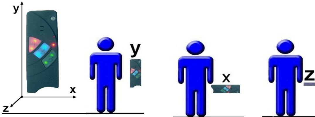
Zum besseren Verständnis: In der Position Z liegt das Gerät flach auf einer waagerechten Ebene mit der Tastatur nach oben.
