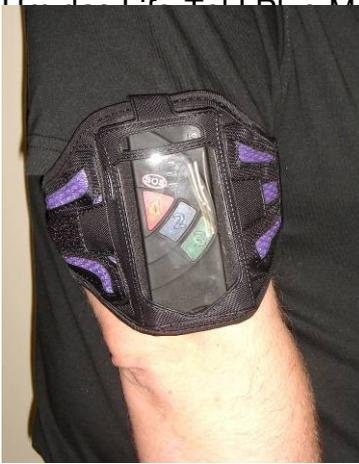
Dieses Gerät kann auch alternativ am Unterarm getragen werden. Dies setzt jedoch voraus, dass man den Winkel des Lagesensors verändert. Mehr zu den Sensoren finden Sie unter 5.4 und 5.6.4.
