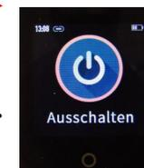
dann drücken Sie und halten gedrückt durch 5 Sek. die Taste EIN, bis die Uhr schaltet sich aus.
