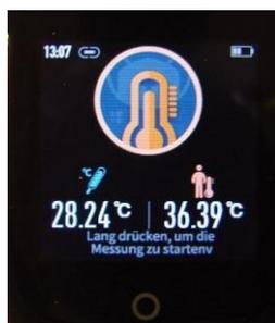
Menü der Temperaturmessung – drücken Sie und halten gedrückt durch 2 Sek. die Taste EIN, um die Messung zu beginnen. Die Messung dauert ca. 60 Sek.
