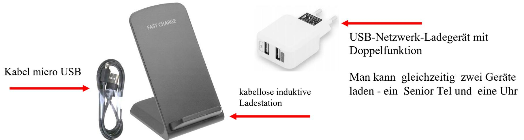
Schließen Sie das USB-Ladegerät über ein USB-Kabel an die kabellose Ladestation an. Das Gerät Senior – Tel II sollte auf der Ladestation platziert werden (wie im Bild unten), eine rote LED sollte leuchten, um anzuzeigen, dass das Gerät geladen wird. Wenn die Diode LED grün leuchten, ist das Gerät vollständig aufgeladen.
