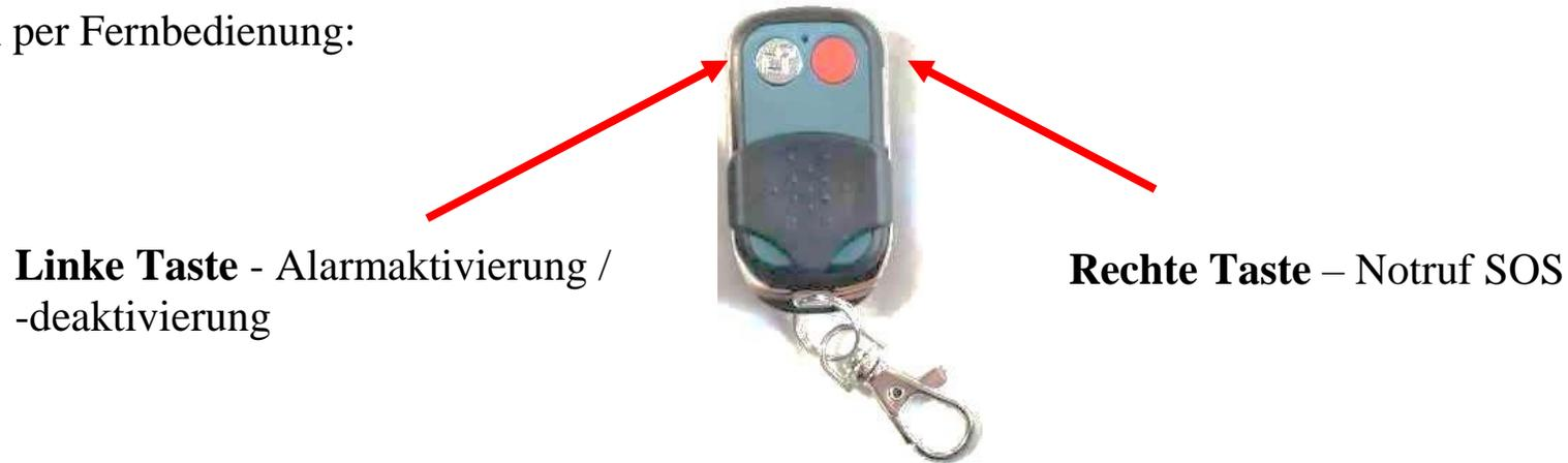
Sie verlassen den Raum und drücken die linke Alarmtaste auf der Fernbedienung. Somit ist das Gerät eingeschaltet. Als Bestätigung hören Sie einen Piepton. Das Ausschalten erfolgt in umgekehrter Folge. Sie drücken die linke Taste. Als Bestätigung hören Sie einen doppelten Piepton.
