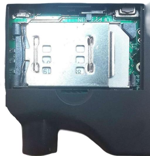
Falls er nicht bereits vom Werk offen ausgeliefert ist, schieben Sie mit leichtem Druck den schwarzen SIM Kartenhalter nach rechts (OPEN), so dass Sie ihn anschließend aufklappen können.
