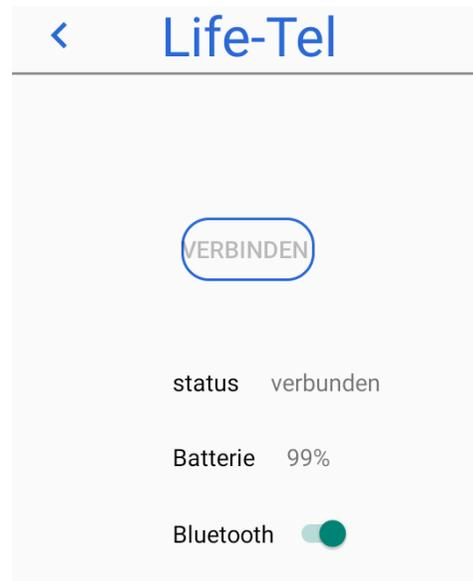
Sie gehen aus dem Bluetooth- Menü zum Hauptbildschirm der App und jetzt, neben der SOS Taste, sehen Sie den Status der Verbindung der Bluetooth- Taste. Sie drücken das Statusfeld (rot), die Farbe sollte sich auf grün ändern. Die grüne Farbe bedeutet, dass die Taste mit dem Gerät verbunden und funktionsbereit ist.
