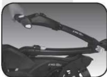
**Paso 3:** Aleje el soporte superior para la bolsa del conjunto de la rueda delantera.
