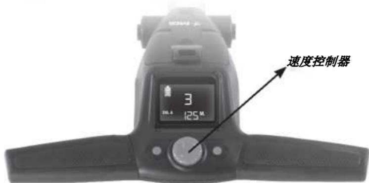
连接电池（参见第 4.2 部分）。如欲选择指定速度，请按照上图所示旋转速度控制按钮。顺时针旋转速度控制按钮可调大速度，逆时针旋转调小速度。选定的速度设置在彩色屏中心显示。如欲以指定速度启动高尔夫球车，请点击速度控制按钮上方。
