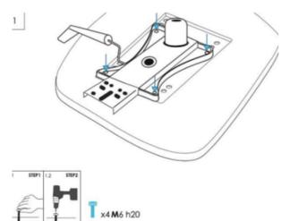
Positionnez le siège à l'envers. Insérez les 4 vis (M6H20) aux emplacements prévus, à la main puis à la visseuse ou au tournevis.
