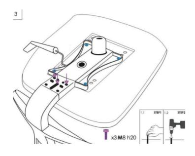
En suite placez y les vis (M8H20) vissez les d'abord à la main, puis à l'aide d'une visseuse ou d'un tournevis
