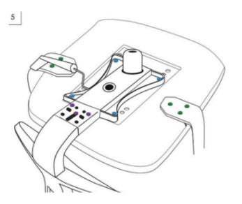
Vous pouvez à présent insérez le piston des pieds dans le fourreau du mécanisme de l'assise.
