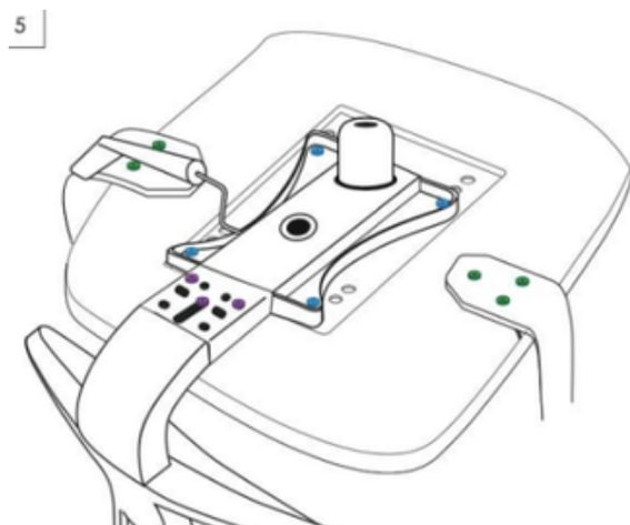
Vous pouvez à présent insérez le piston des pieds dans le fourreau du mécanisme de l'assise.
