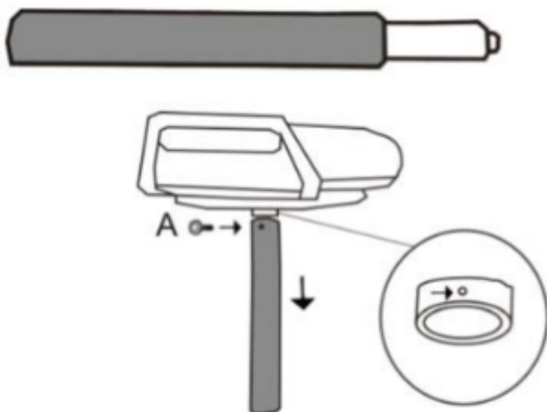
Mettez le tube de finition en métal sur le tuyau d'élévation
