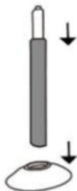
Mettez le bouton du tuyau d'élévation vers le haut et mettez le bas dans le couvercle en plastique puis déposer la structure sur la base.
