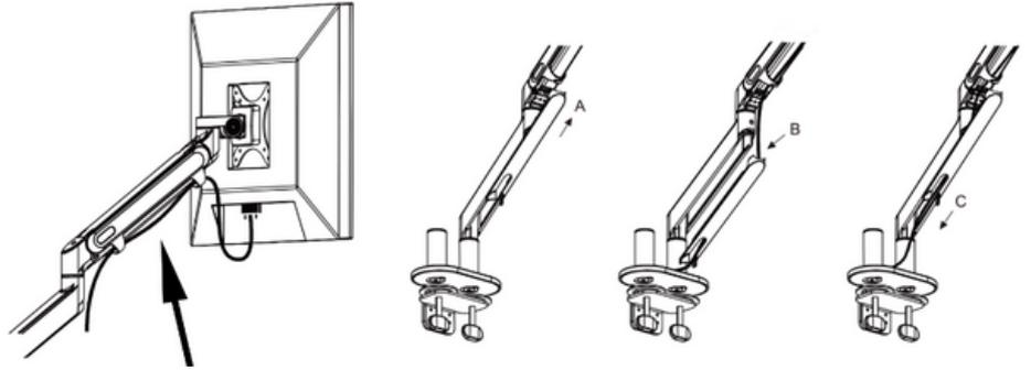
2. Glisser le cache en plastique A et le retirer de la partie inférieure du bras puis placer les câbles à l'intérieur contre le cache B, puis le glisser à nouveau en position jusqu'à entendre un clic.
