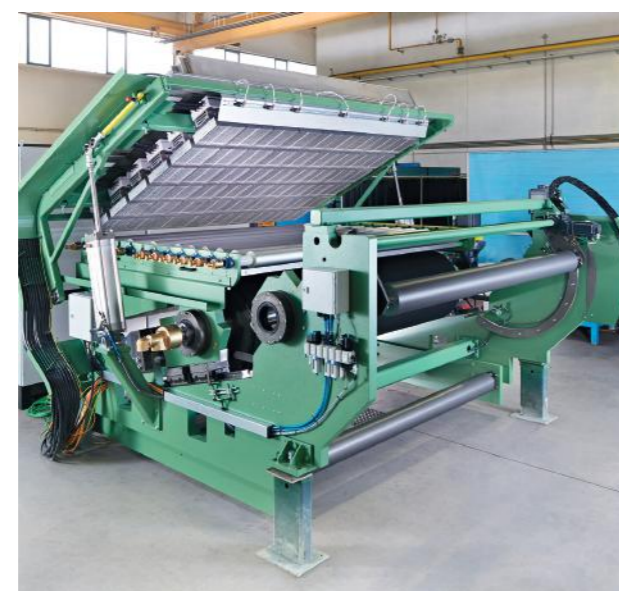
KRELUS Infrarot-Vorheizung für Prägeanlagen Quelle: Kampf LSF GmbH, Laussig, DE
