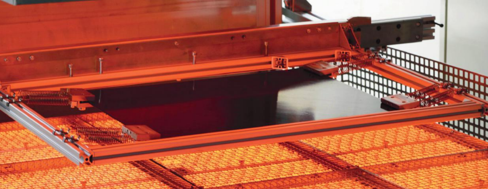
Homogenes Erwärmen eines Organoblechs Quelle: Fraunhofer IPT
