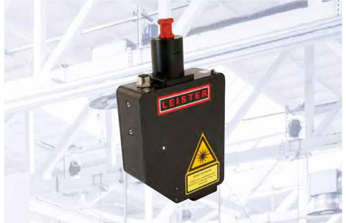
Die Spot Optic fokussiert den Laserstrahl auf einen Punkt (Spot) und wird meist zum Konturschweißen eingesetzt. Die Brennweiten der eingesetzten Fokussierlinsen bestimmen hierbei den Spotdurchmesser, der wiederum maßgeblich für die Schweißnahtbreite ist. Der Laserstrahl kann also durch den Austausch optischer Komponenten auf die individuellen Anforderungen beim Kunststoffschweißen angepasst werden.
