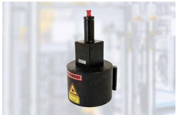
Mit der Radial Optic ist rotationsloses Laserschweißen ohne zusätzliche Spanntechnik möglich. Das Radialschweißen eignet sich für rotationssymmetrische Bauteile, die sich selber schlecht rotieren lassen. Die Laserstrahlung wird über einen konischen Spiegel auf den Umfang der Bauteile abgelenkt. Dadurch können Bauteile mit einem Durchmesser bis zu Ø68mm simultan geschweisst werden. Vorteile sind kurze Zykluszeiten und ein hoher Durchsatz.
