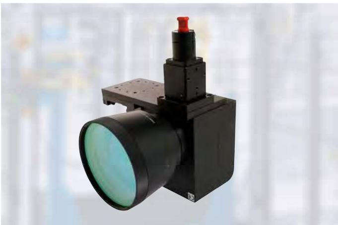
Die Scanner Optic zeichnet sich durch die integrierte Option der Bewegung aus und wird hauptsächlich zum Quasisimultanschweißen eingesetzt. Mit zwei beweglichen Spiegeln wird ein punktförmiger Laserstrahl entlang einer programmierten Kontur geführt. Die Größe des Arbeitsfeldes kann durch verschiedene Fokussierlinsen eingestellt werden. Wie alle optischen Komponenten kann auch die Scanner Optic in alle Novolas™-Laserschweißsysteme eingebaut werden.
