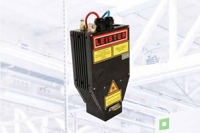
Der LineBeam ist die ideale Strahlquelle zum Maskenschweißen. Er erzeugt eine Linie mit nahezu konstanter Leistungsdichteverteilung, wodurch ein gleichbleibendes Schweißbild erlangt wird. Der LineBeam ist ein kompaktes System, das aus einem Diodenlaser und einer direkt angekoppelten Optik besteht. Die optischen Komponenten des Systems können auf verschiedene Linienlängen eingestellt werden.
