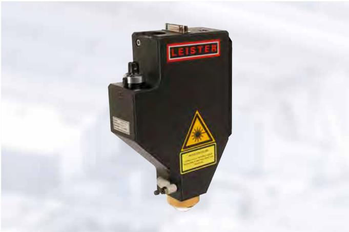
Mit der Globo Optic ist das Schweißen in 2-D oder auch 3-D ohne komplexe Spanntechnik möglich. Die luftgelagerte Glas-kugel fokussiert die Laserstrahlung und dient gleichzeitig als mechanisches Andruckwerkzeug. Während die Kugel auf dem Bauteil abrollt, drückt sie permanent und punktuell auf die Fügeebene. Somit trifft die Laserstrahlung nur dort auf, wo auch Anpresskraft vorhanden ist.
