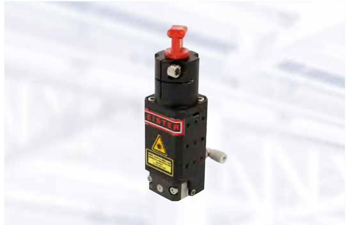
Die Roller Optic benötigt keine zusätzliche Spanntechnik. Bei der Roller Optic wird ein linienförmiger Laserstrahl durch eine Glasrolle geleitet, die sowohl Andruckwerkzeug als auch letztes optisches Element ist. Die zweiseitig gelagerte Rolle kann Schweissnahtbreiten von etwa 3.0 – 6.7 mm erzeugen. Durch die Pendellagerung der Rolle sind kleine Unebenheiten in axialer Richtung kompensierbar.
