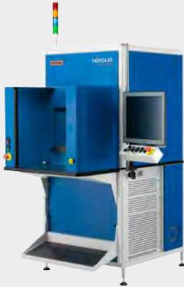
Die Laserschweißanlage NOVOLAS™ WS AT RTT ist mit Rundtaktisch (RTT) verfügbar. Der RTT ist ein optionales Modul, das aufgrund höherer Zykluszeit den Durchsatz und die Wirtschaftlichkeit erhöht.
