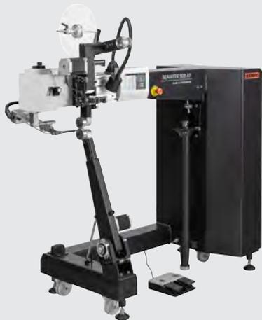
Mit der wartungsarmen Schweißmaschine SEAMTEK 900 AT gelangen selbst unerfahrenen Anwenderinnen und Anwendern perfekte Überlappnähte, Säume, Keder- und Bandaufschweißungen. Intuitive Bedienung via Touch-Screen inklusive.
