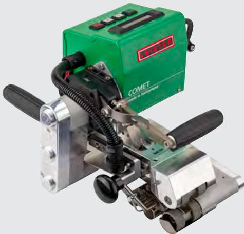
Der Heizkeilschweissautomat COMET ist kompakt und leicht zu transportieren. Er wird im Tunnelbau zum Überkopfschweissen und vertikalen Abdichten eingesetzt.
