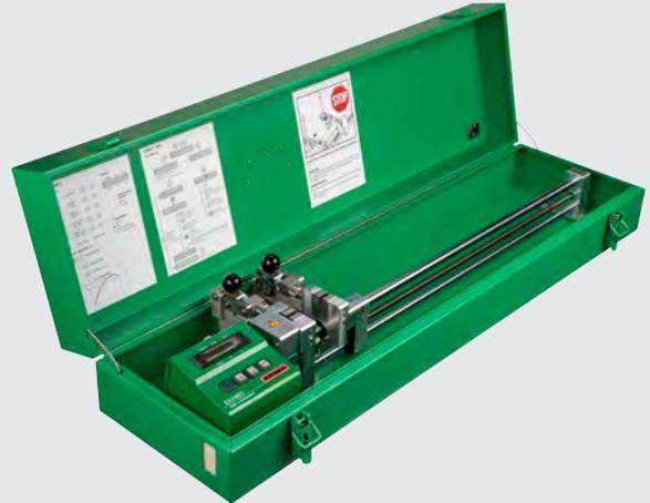
Der EXAMO 600F USB ist das ideale Prüfgerät zum Testen der Schweißnaht von hochelastischen Membranen bezüglich Schälkraft, Zugfestigkeit und Scherfestigkeit – weltweit erprobt und bewährt.
