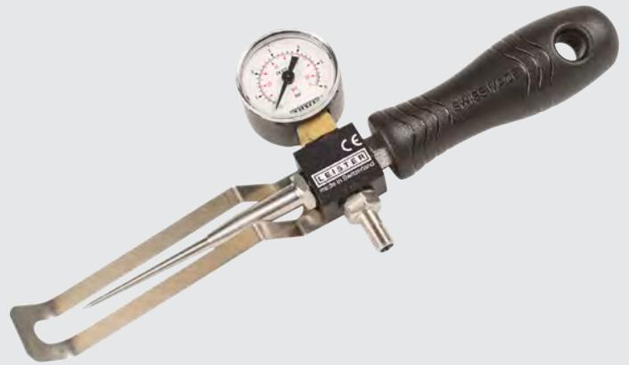
Die Prüfnadel ist ein zuverlässiges Druckluftprüfgerät zum Testen der Dichtigkeit von Überlappnähten mit Prüfkanal. Entwickelt zur Qualitätssicherung von Schweissnähten im Tiefbau, im Tunnel und auf der Deponie.
