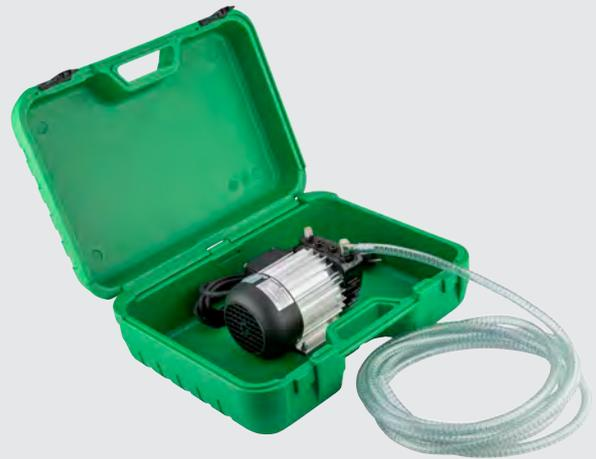
Die VACUUM PUMP erzeugt das Vakuum für die Prüflocken BOX und BELL zum Testen der Dichtigkeit von Kunststoff-Schweissnähten.
