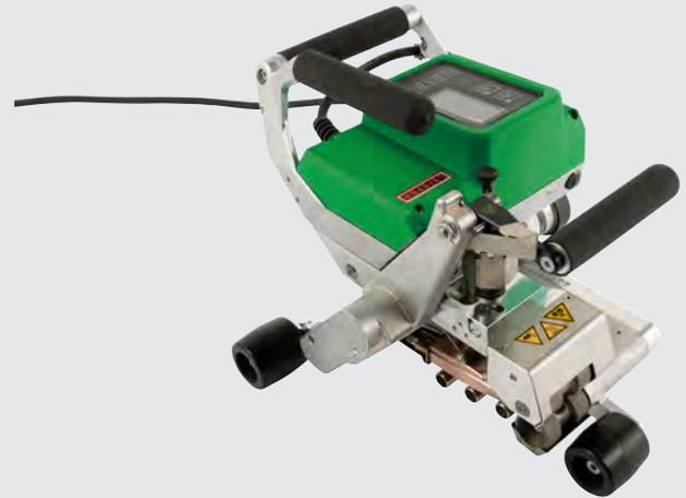
Der Heizeilschweissautomat COMET 500 ist kompakt gebaut und leicht zu transportieren. Er eignet sich vor allem zum sicheren Verschweissen von dicken und dünnen Geomembranen aus PE, HDPE und LDPE im Tiefbau.
