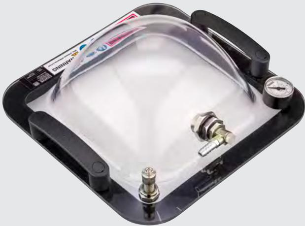
Die VACUUM BELL ist eine praktische Prüflocke aus Kunststoff. Sie wird besonders im Deponie- und Tunnelbau zum Prüfen der Dichtigkeit von Überlappschweissnähten verwendet.
