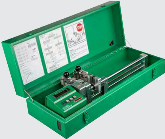
Der EXAMO 300F USB ist das ideale Prüfgerät zum Testen der Schweißnaht von Membranen auf ihre Schälkraft, Zugfestigkeit und Scherfestigkeit – weltweit erprobt und bewährt.
