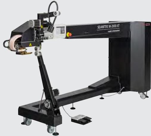
Die Schweißmaschine SEAMTEK W-2000 AT bietet Anwender:innen beim Arbeiten noch mehr Platz als die SEAMTEK W-900 AT. Dadurch ist effizientes und sicheres Schweißen von grossen Produkten aus technischen Textilien möglich.
