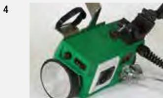
Der **Schnell-Klemmverschluss für die TRIAC-Halterung** erlaubt eine Montage bzw. Demontage des TRIAC innert weniger Sekunden. Die Stromversorgung für das Handgerät ist in der MINIFLOOR Drive Unit integriert, wie auch die Möglichkeit das Kabel zu fixieren.
