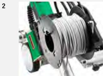
**Werkzeuglose Montage / Demontage des De-reelers:** Falls der de-reeler nicht eingesetzt werden kann, kann der Schweissdraht trotzdem kontrolliert in die Schweissdüse geführt werden.
