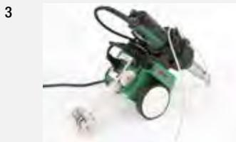
**Unglaublich schnell:** Trotz seines geringen Gewichts bietet der MINIFLOOR eine Schweissgeschwindigkeit von rund 2 m/min, was nahezu einer Verdoppelung gegenüber der Schweissgeschwindigkeit beim Handschweißen entspricht.
