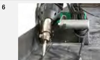
Der **minimale Wandabstand von nur 51 mm** sorgt für problemloses Verschweißen von gängigen Hohlkehlen oder auch Hochzügen. Die kompakte niedrige Bauhöhe ermöglicht durchgängiges Schweißen bereits ab 295 mm tiefen Durchgängen.
