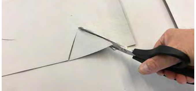
Leister Schere mit Spezial Wellenschliff für hohe Anforderungen beim Kunststoffbahnen schneiden.
