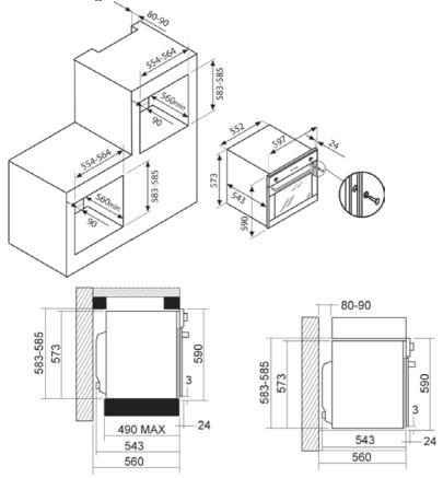
UNDER BENCH INSTALLATION TOWER INSTALLATION
