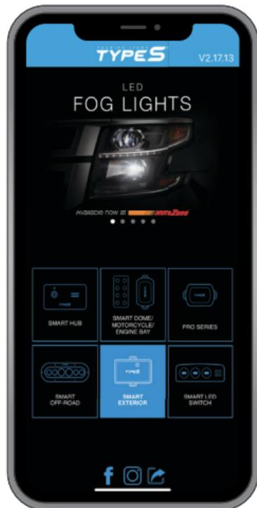
Tapez sur l'icône « SMART EXTERIOR » pour commencer. L'application se jumelle automatiquement au concentrateur lorsque les lampes pour passage de roue et votre appareil sont en marche et dans la portée Bluetooth® de 9,14 m (30 pieds). Nous vous recommandons fortement de configurer un mot de passe privé pour éviter que des appareils non autorisés ne se connectent au concentrateur intelligent. (Consultez les instructions concernant le mot de passe à la page 37)
