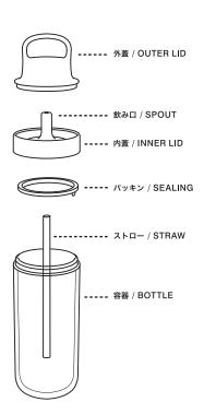
シリコーンパーツの向きを正しく装着してご使用ください Please attach silicone parts in the correct direction.
