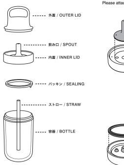
シリコーンパーツの向きを正しく装着してご使用ください Please attach silicone parts in the correct direction.
