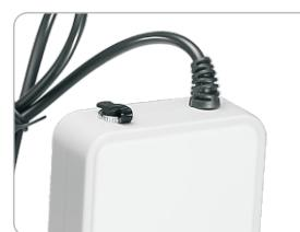
左側は充電器のコンセントであり、使わない時はゴムキャップをかけ、短絡して電池を壊したり、意外な事故が発生したりしないようにします。
