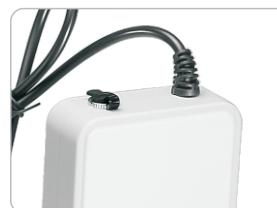
A la izquierda está el enchufe del cargador. La tapa de goma debe sujetarse cuando no esté en uso para evitar daños por cortocircuitos en la batería o accidentes.
