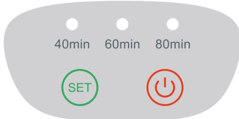
Nach dem Einschalten leuchtet standardmäßig das erste Licht, drücken Sie erneut, um das zweite Licht einzuschalten, drücken Sie ein drittes Mal, um das dritte Licht einzuschalten, drücken Sie ein vieres Mal, um alle drei Lichter gleichzeitig einzuschalten.
