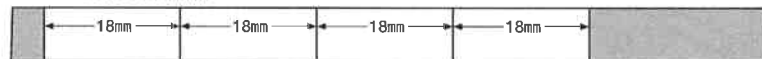
BT6 ゴムパイプ Rubber tubing Gummirohr Tube caoutchouc ×1 ★18mmに切ります。 ★Cut out to 18mm. ★Auf 18mm zuschneiden. ★Découper à 18mm.
